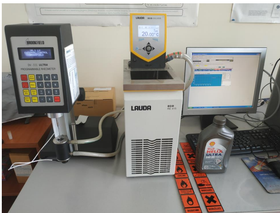
Slika 5. Eksperimentalni postav za mjerenje dinamičke viskoznosti rotirajućim tijelom
