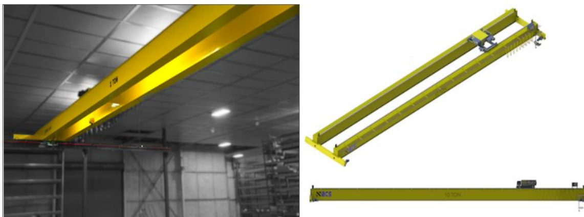
Slika 11. Dvogredni mosni granik iz kutijastih profila [9]
