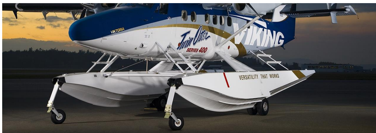
Slika 4. Podvozje izvedeno kao plovak [5]
