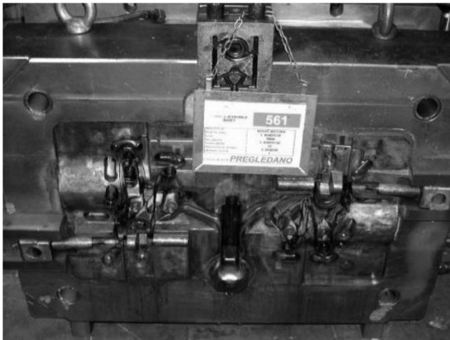
Slika 9. Pravilno označavanje alata [16]
