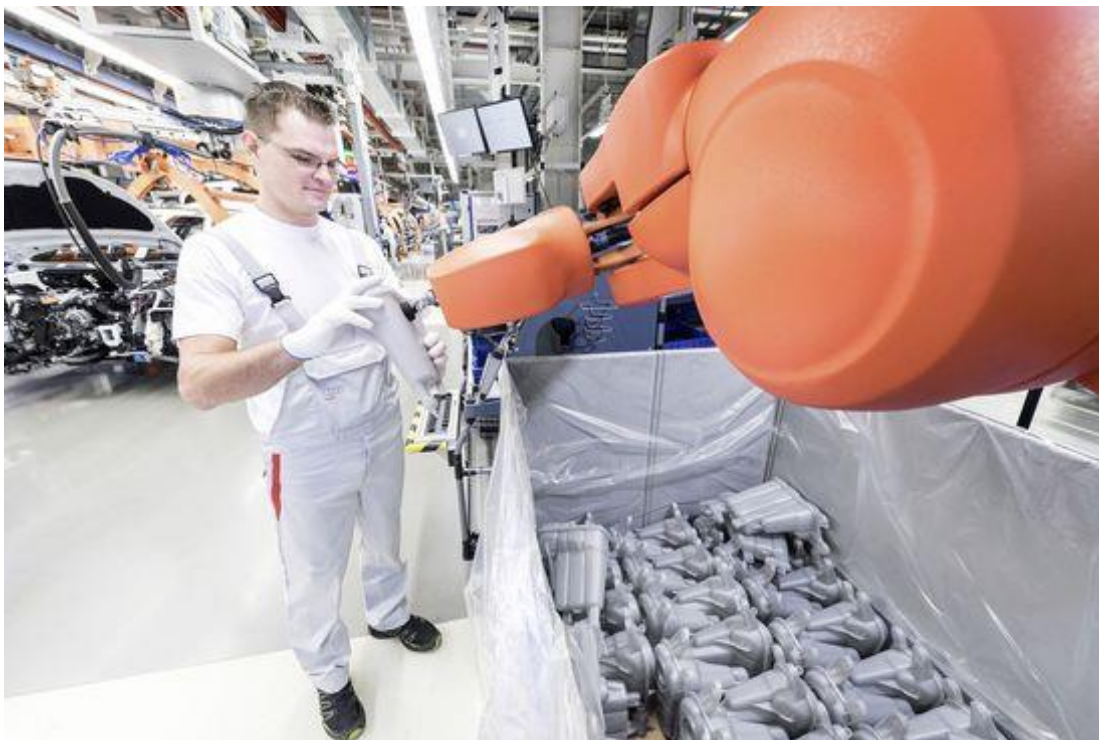
Slika 6. Robot PART4you (KUKA) radi ruku pod ruku s ljudima bez ikakvih sigurnosnih prepreka [11]
