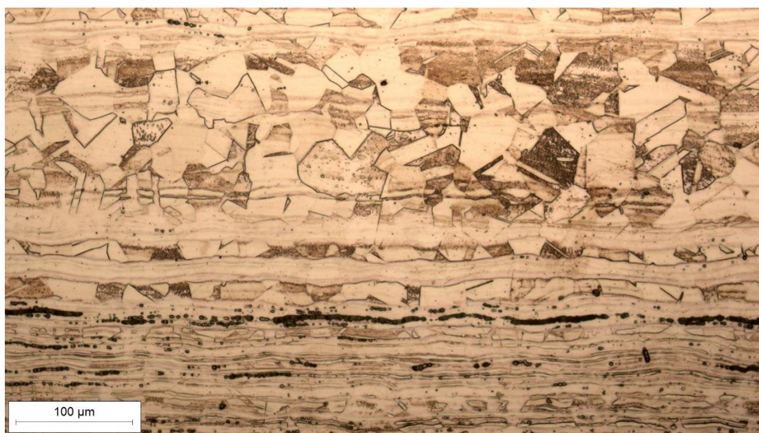
Slika 32 Mikrostruktura poprečnog presjeka analizirane pločice od austenitnog nehrđajućeg čelika oznake X2CrNiMo17-12-2
