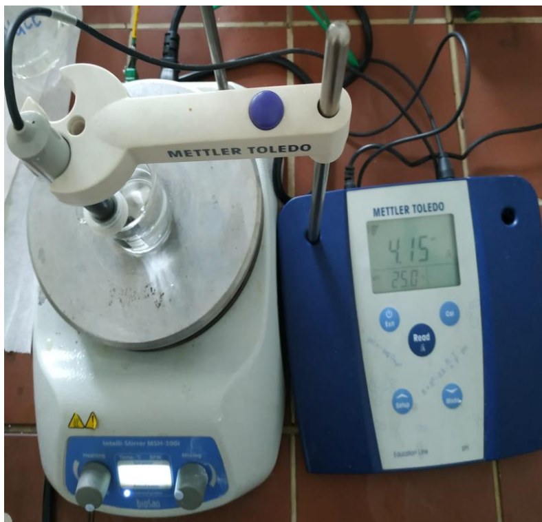
Slika 13 Određivanje pH vrijednosti otopine 3
