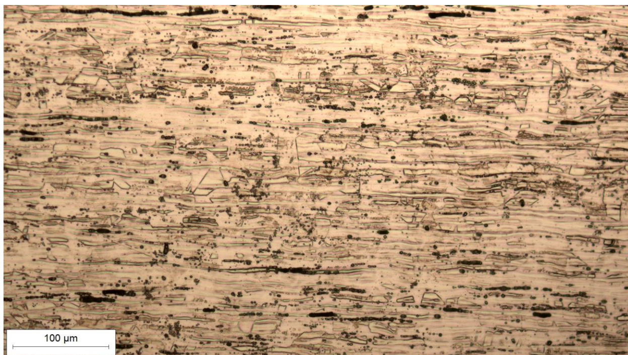
Slika 24 Mikrostruktura sredine poprečnog presjeka uzorka 1, snimljeno pri povećanju 200×
