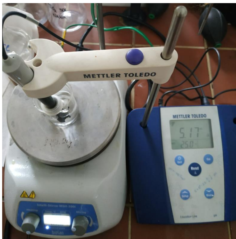
Slika 12 Određivanje pH vrijednosti otopine 2
