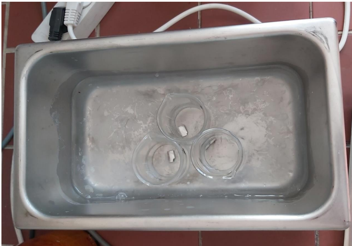
Slika 14 Čišćenje uzoraka u ultrazvučnoj kupelji
