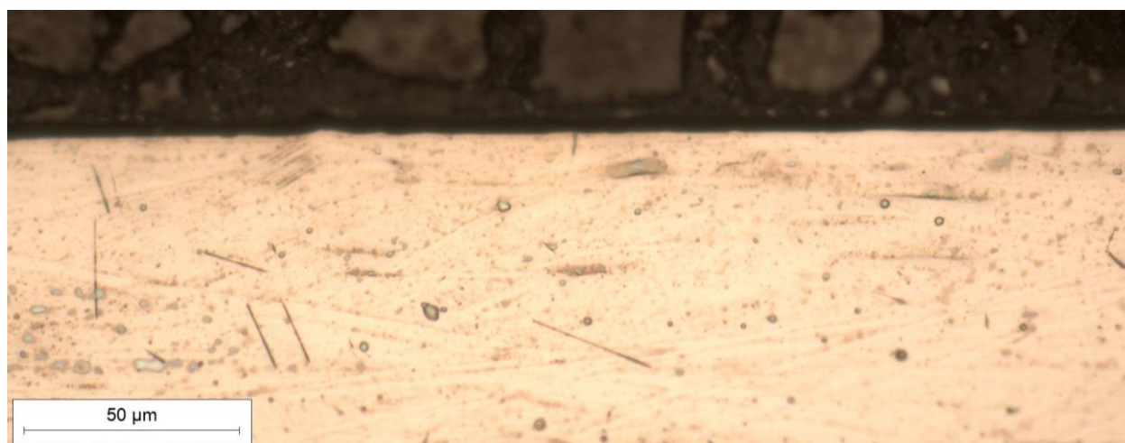
Slika 28 Mikrostruktura ruba poprečnog presjeka uzorka 3, snimljeno pri povećanju 500×
