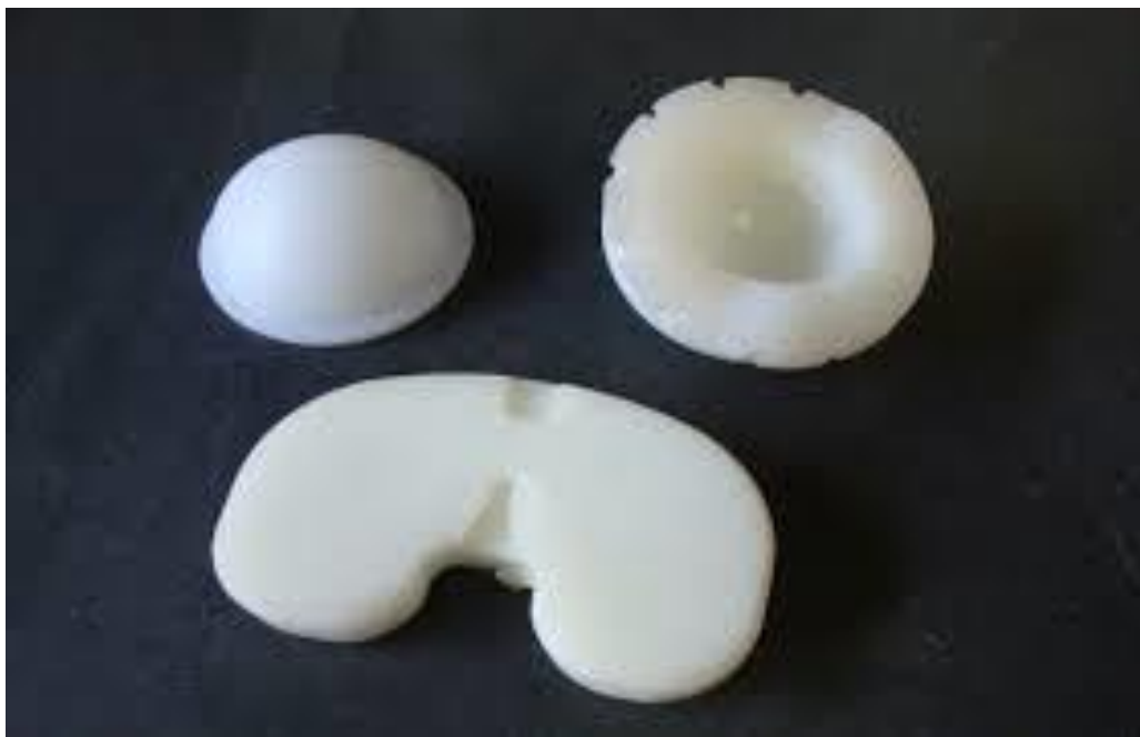
Slika 7. Dijelovi ortopedskih implantata od UHMWP-a [24]
