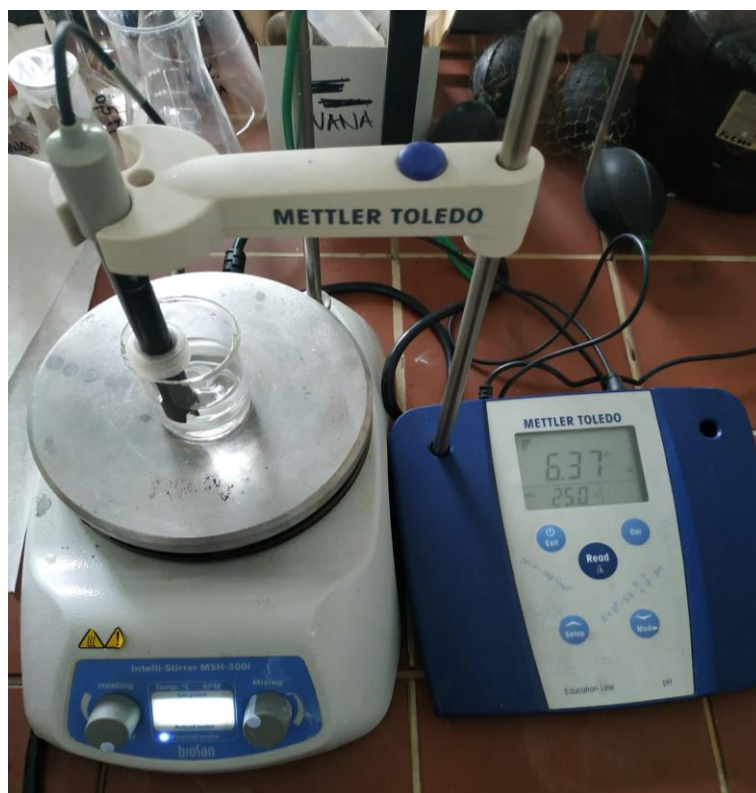
Slika 11 Određivanje pH vrijednosti otopine 1
