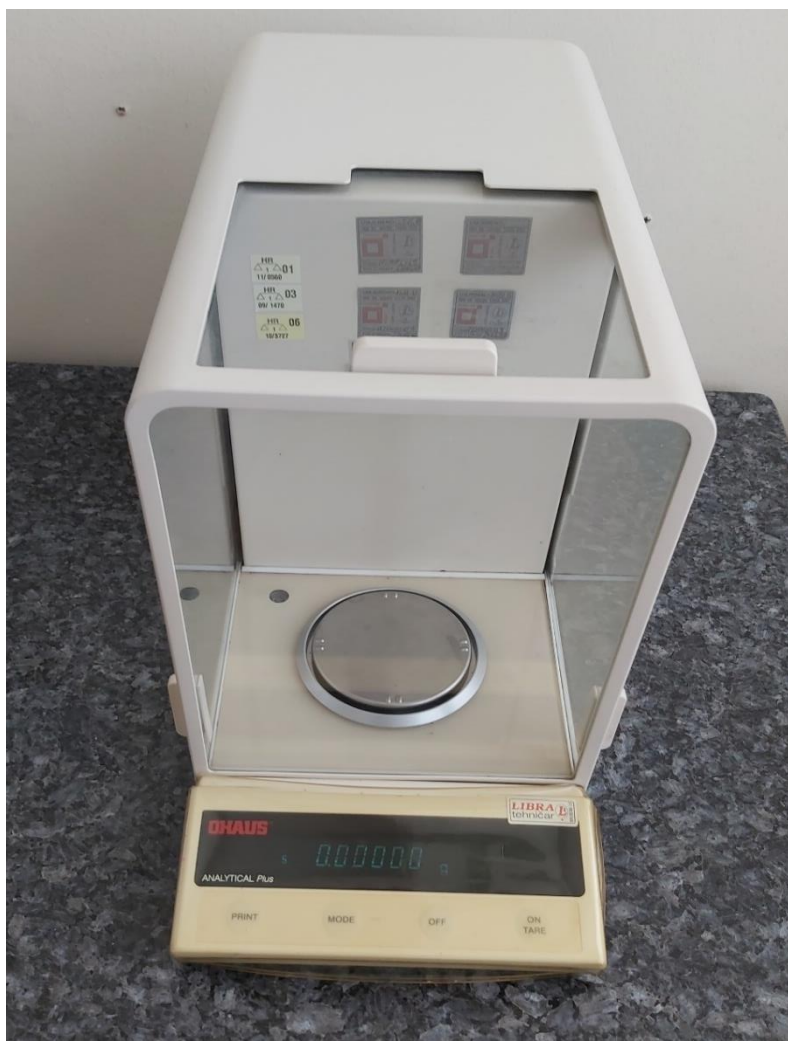
Slika 18 Analitička vaga proizvođača OHAUS
