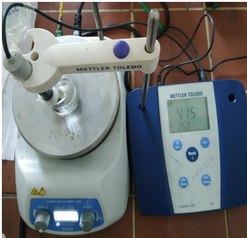
Slika 13 Određivanje pH vrijednosti otopine 3
