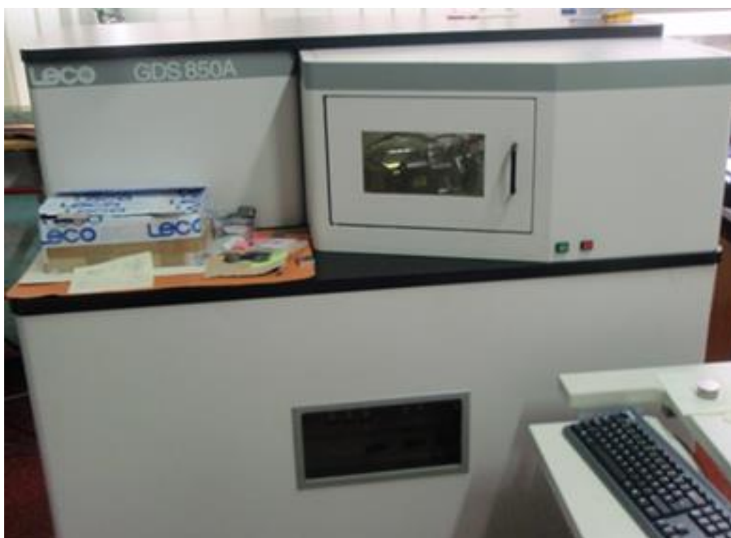
Slika 17 uređaj za optičku emisijsku spektroskopiju GDS 850A
