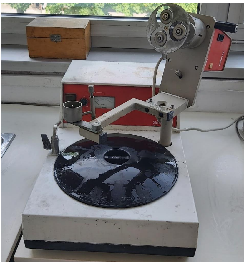
Slika 22 Struers DAP-V uređaj za poliranje
