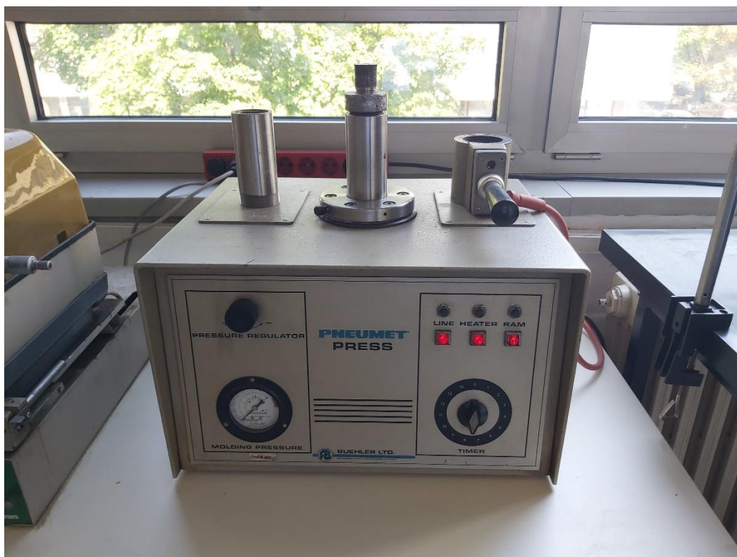
Slika 19 Pneumatska preša za zalijevanje uzoraka
