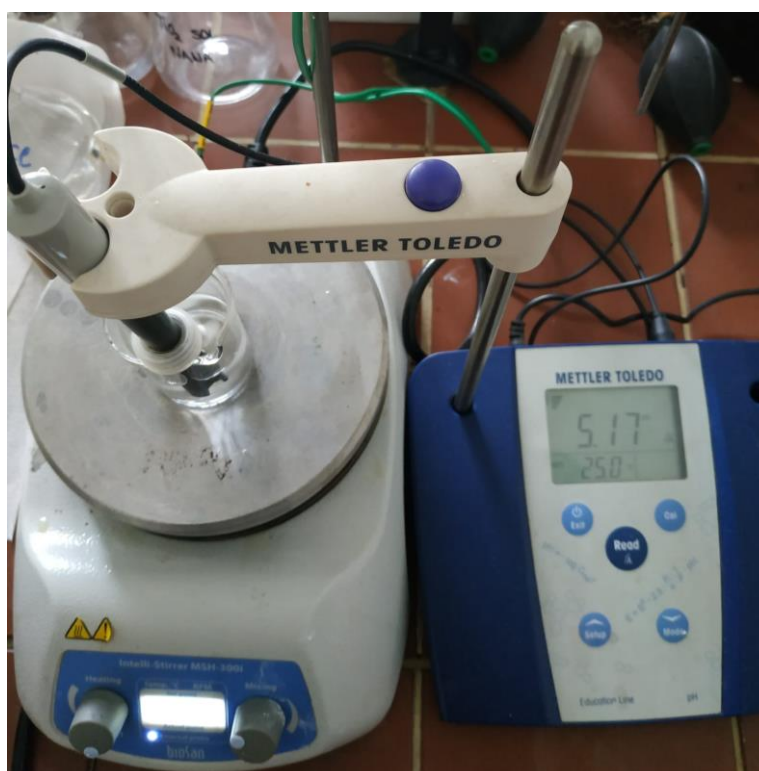
Slika 12 Određivanje pH vrijednosti otopine 2
