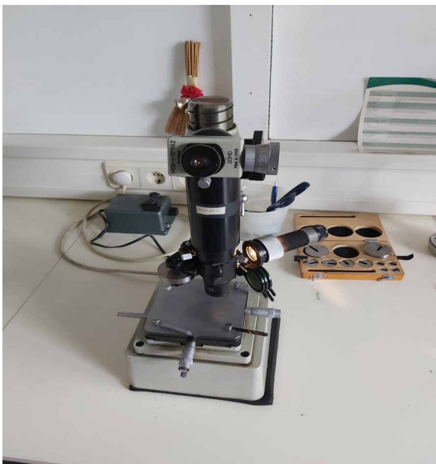
Slika 29 Mikrotvrdomjer oznake PMT-3
