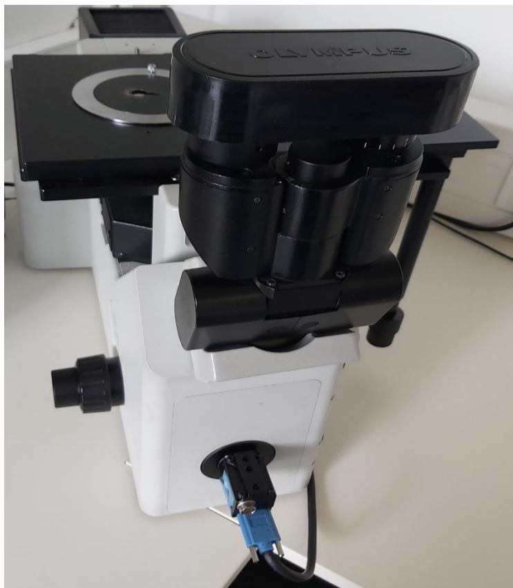
Slika 23 Svjetlosni mikroskop Olympus GX51
