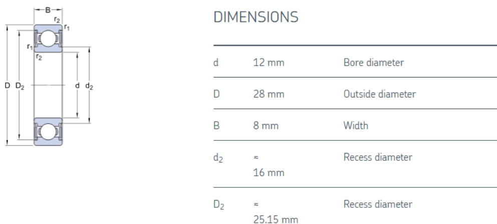
Slika 33. Dimenzije ležaja W 6001 - 2RS1
