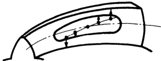
**Slika 6.** Slika nošenja stožnika sa zakrivljenim zubima
