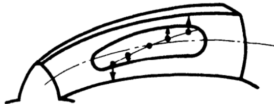
Slika 6. Slika nošenja stožnika sa zakrivljenim zubima
