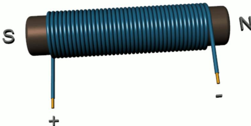
Slika 4. Bakreni namotaji oko željezne jezgre [3]
