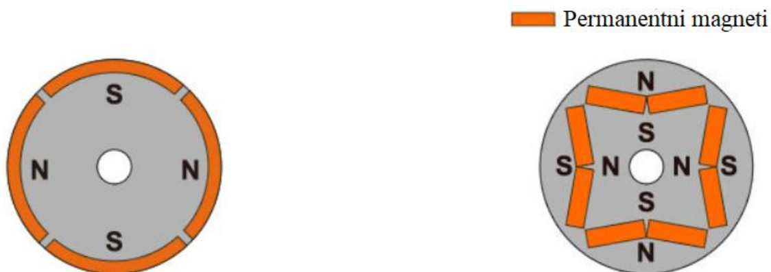
Slika 7. SPM (lijevo) i IPM (desno) [32]
