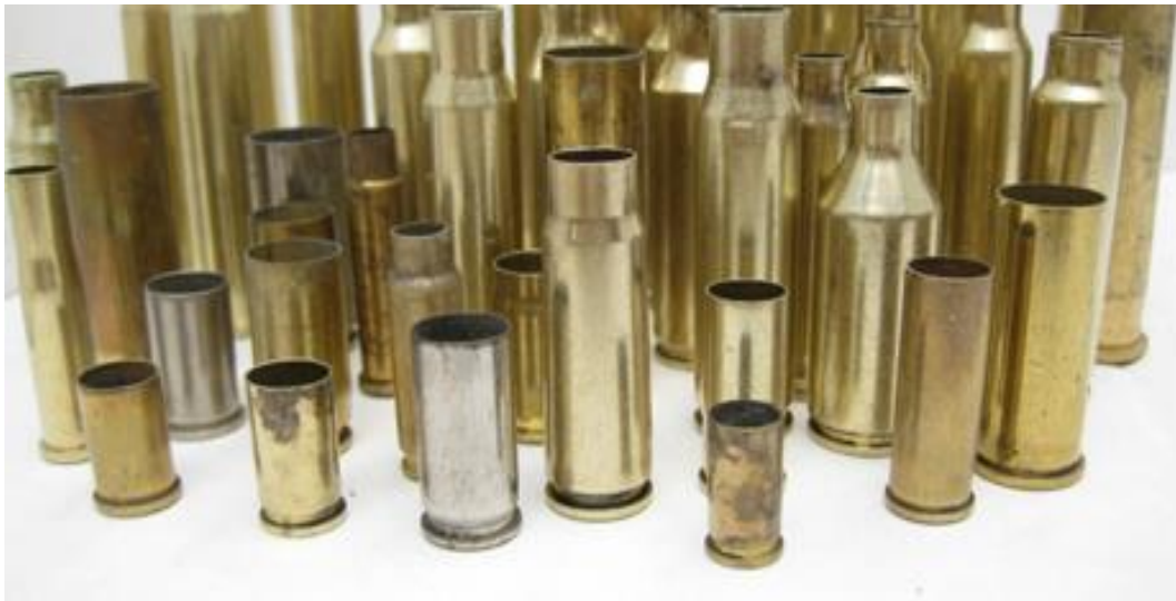
Slika 7. Patrone načinjene od mesinga 70-30 [24]
