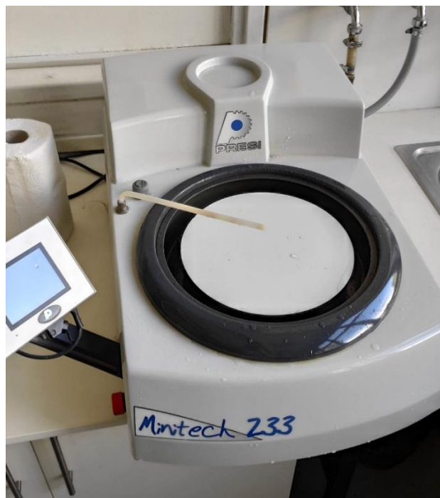
Slika 15. Laboratorijski uređaj za brušenje Minitex 233
