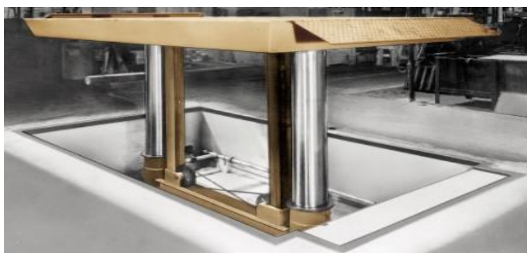
Slika 13. Stupna podizna platforma s hidrauličkim cilindrima
