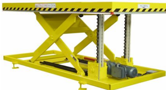
Slika 19. Podizna platforma pogonjena mehanizmom s lancem
