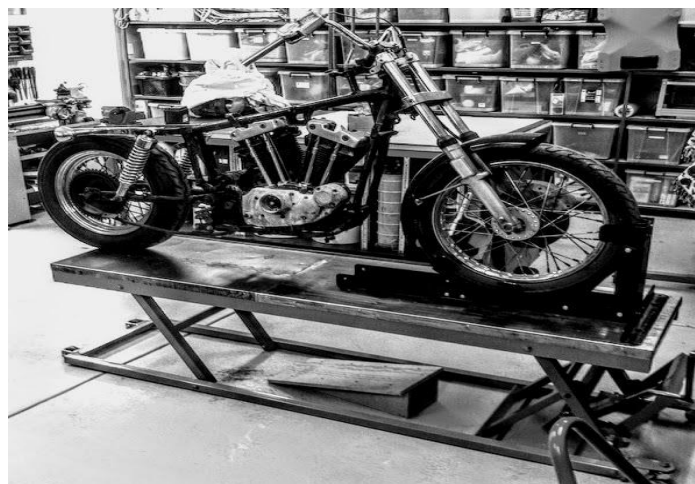
Slika 6. Radionička podizna platforma sa zglobnim paralelogramom za popravak motocikla
