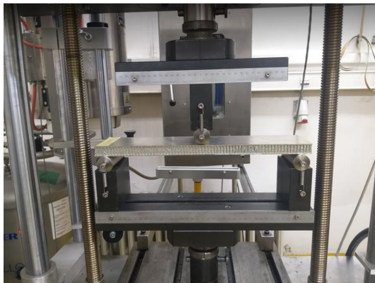
Slika 45. Postavljanje uzoraka na kidalicu
