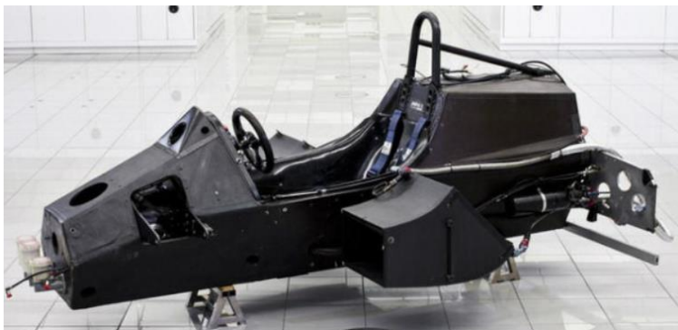
Slika 2. Monokok šasija formule McLaren MP4/1C [2]
