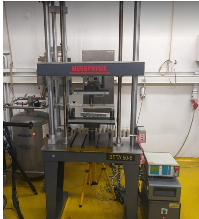
Slika 44. Kidalica MESSPHYSIK BETA 50-5
