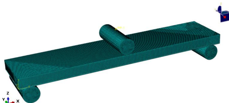
Slika 30. Diskretizirani prvi numerički model sa konačnim elementima
