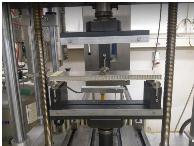
Slika 45. Postavljanje uzoraka na kidalicu
