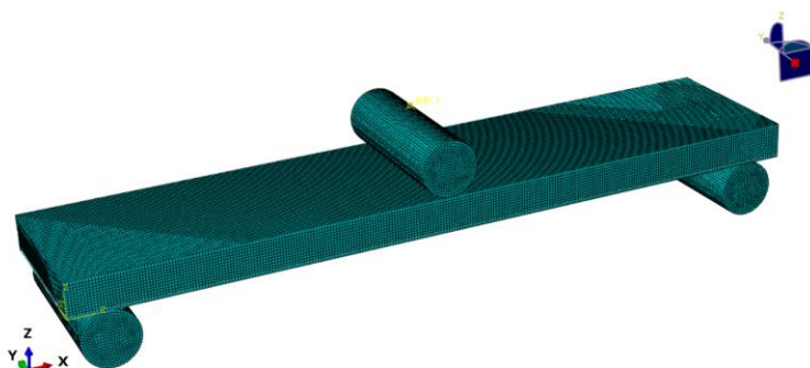
Slika 30. Diskretizirani prvi numerički model sa konačnim elementima
