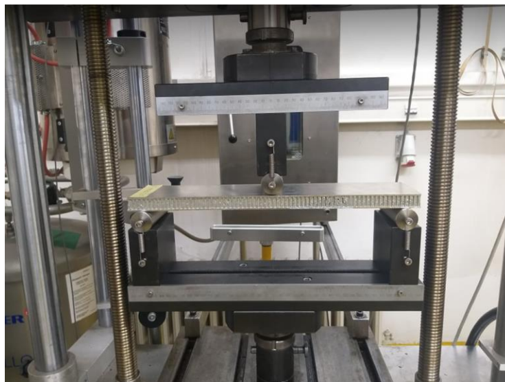
Slika 45. Postavljanje uzoraka na kidalicu
