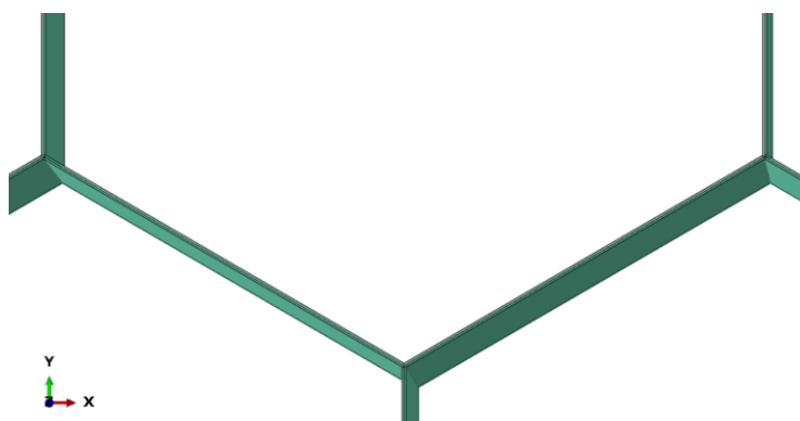
Slika 36. Rendirani prikaz Shell modela jezgre od aluminisjkih saća
