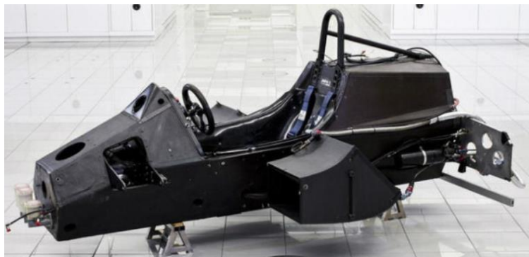
Slika 2. Monokok šasija formule McLaren MP4/1C [2]
