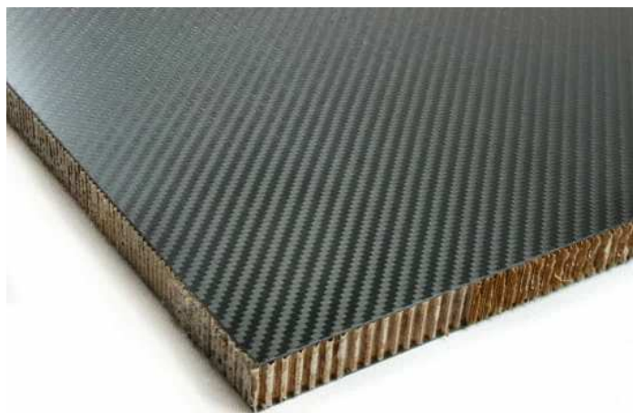
Slika 9. Nomex i CFRP sandwich[11]
