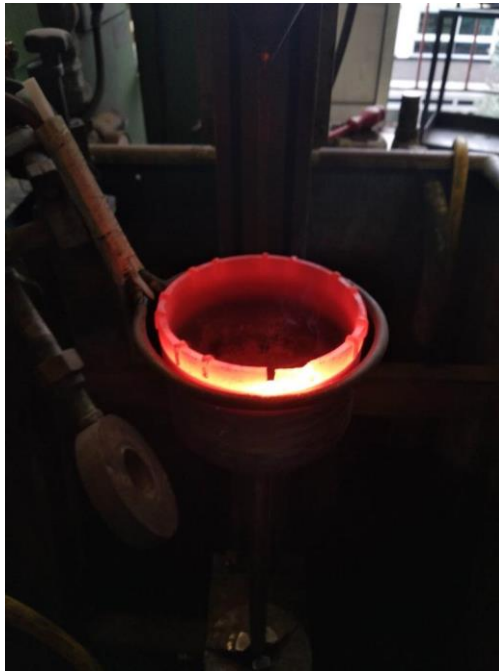
Slika 26 Izbijanje oštrica na temperaturi popuštanja lema
