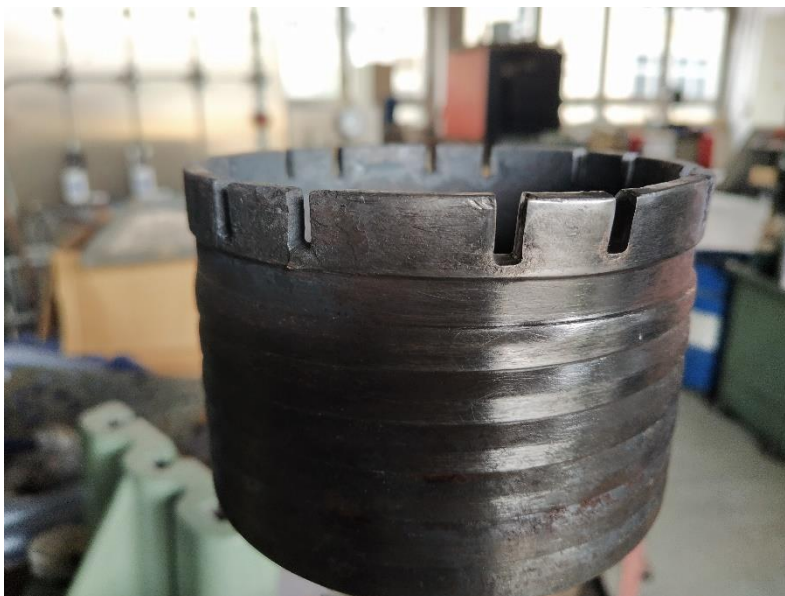
Slika 32 Površina krune pripremljena za lemljenje
