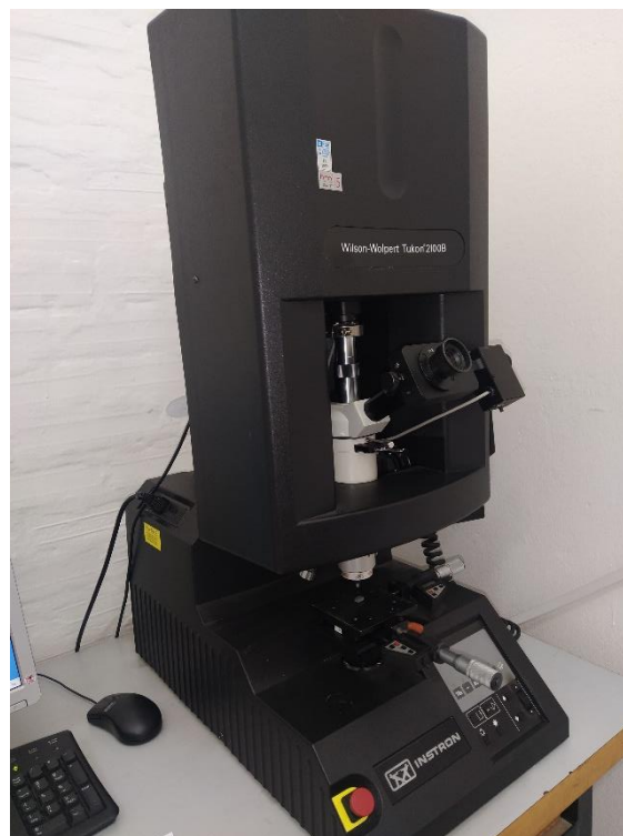
Slika 30 Uređaj za mjerenje tvrdoće Tukon 2100b
