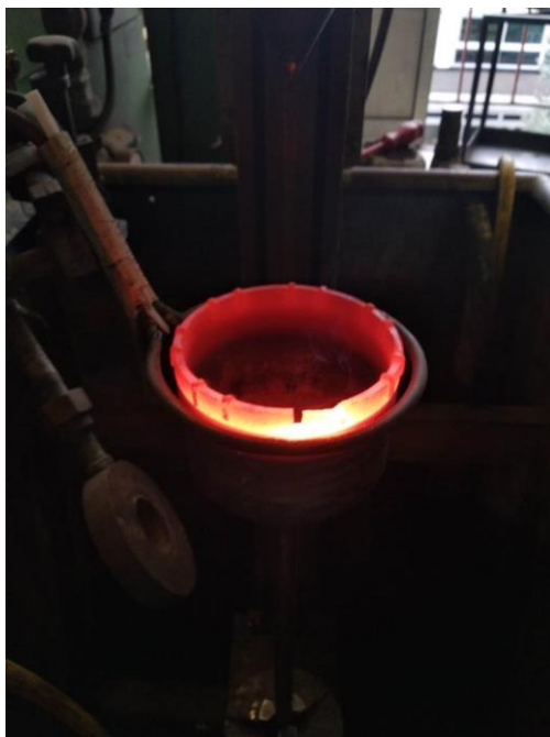
Slika 26 Izbijanje oštrica na temperaturi popuštanja lema
