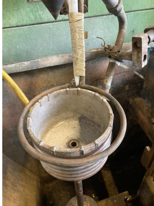
Slika 24. Pozicija induktora za ugrijavanje
