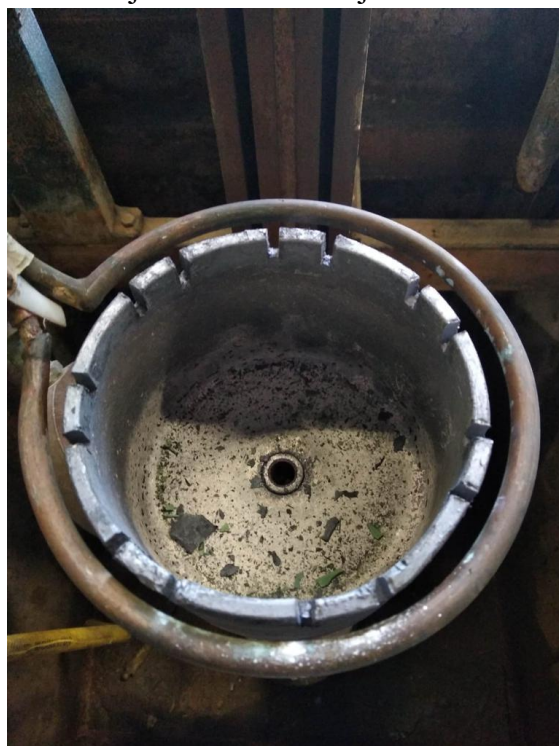
Slika 27 Kruna nakon uklanjanja oštrica
