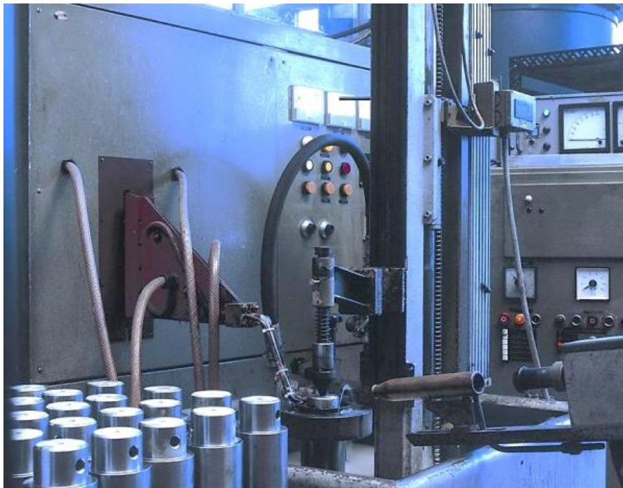
Slika 22 Uređaj za indukcijско kaljenje
