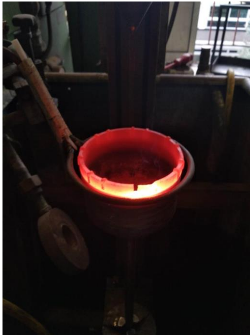
Slika 26 Izbijanje oštrica na temperaturi popuštanja lema
