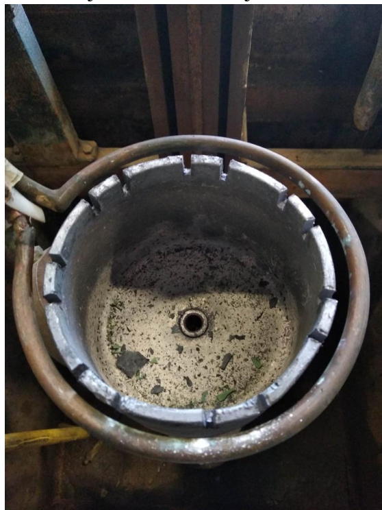
Slika 27 Kruna nakon uklanjanja oštrica
