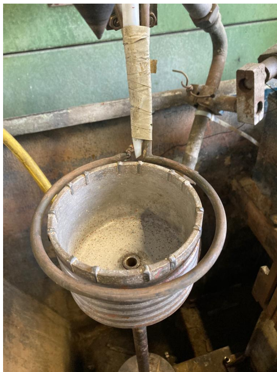
Slika 24. Pozicija induktora za ugrijavanje
