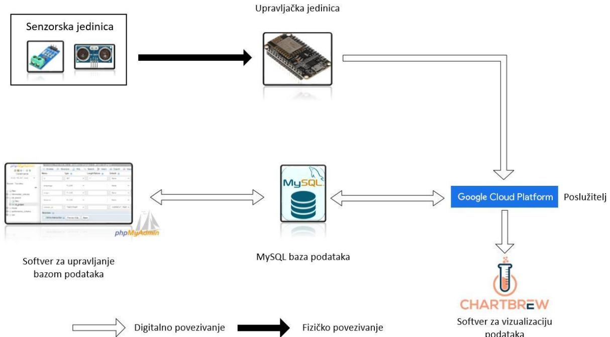
Slika 4.4. Shematski prikaz arhitekture digitalnog proizvoda sokovnika
