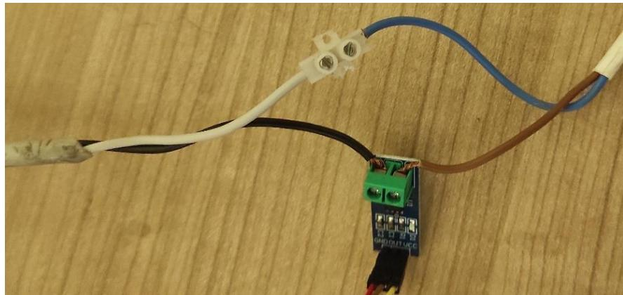
Slika 4.12. Integracija senzora u strujni krug
