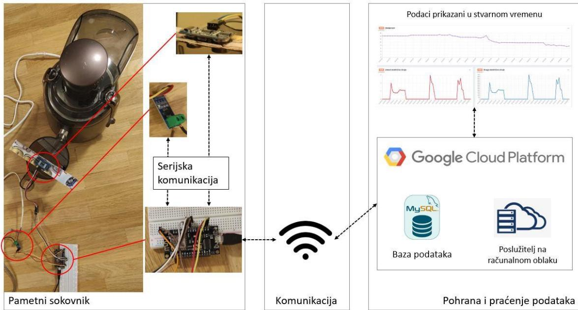
Slika 4.3. Apstraktan prikaz arhitekture digitalnog blizanca
