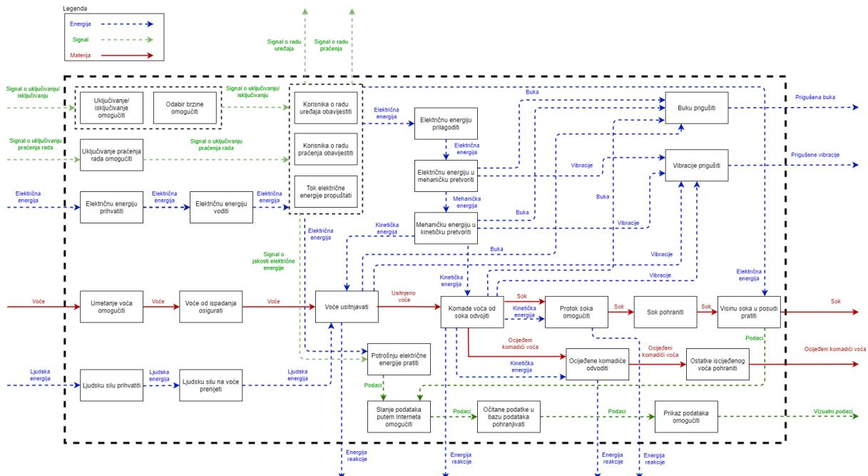
Slika 4.5. Funkcija dekompozicija digitalnog blizanca sokovnika
