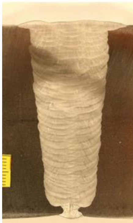
Slika 18. Izgled pripremljenog makroizbruska [26]
