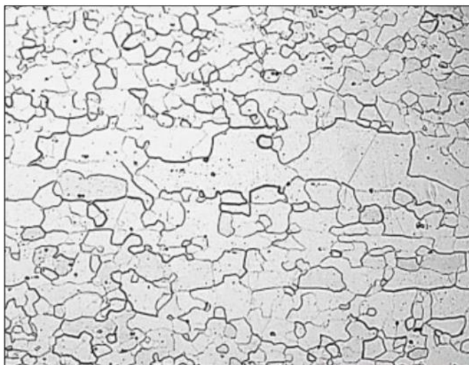
Slika 3. Mikrostruktura feritnih nehrđajućih čelika [9]
