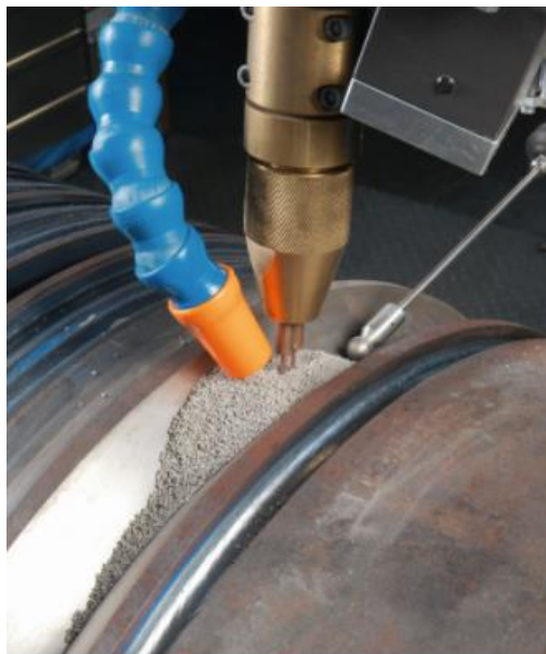
Slika 7. Zavarivanje pod zaštitom praška [18]
