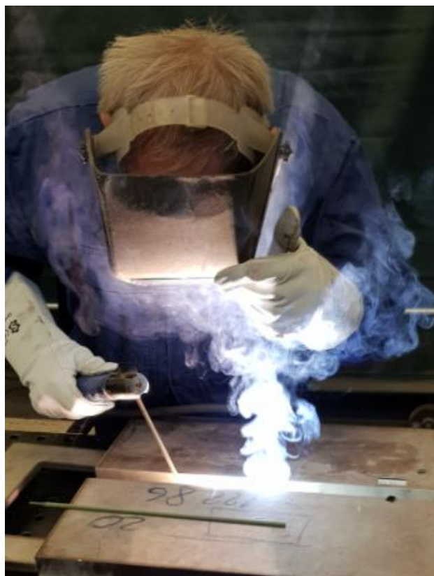
Slika 16. Proces izrade zavara REL tehnologijom
