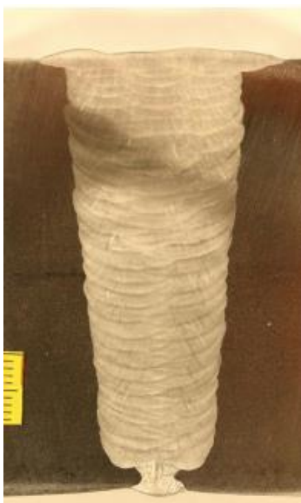
Slika 18. Izgled pripremljenog makroizbruska [26]
