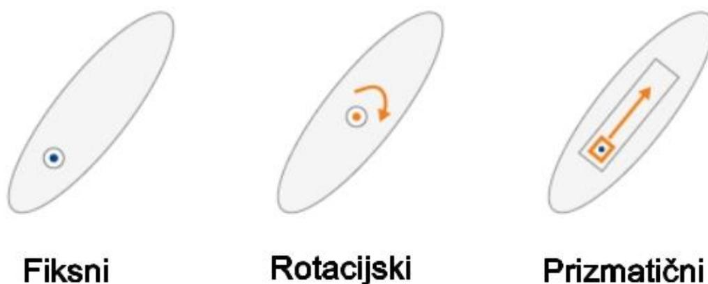
Slika 5. 2 Shematski prikaz zglobova [1]
