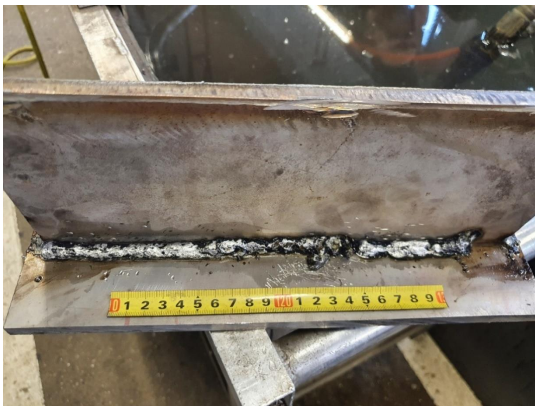
Slika 42. Izgled zavara nakon podvodnog zavarivanja
