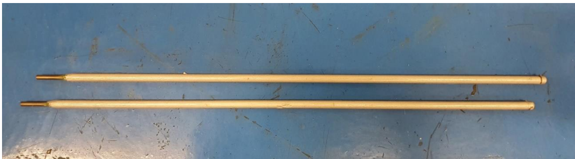
Slika 39. Vodonepropusne elektrode za podvodno zavarivanje
