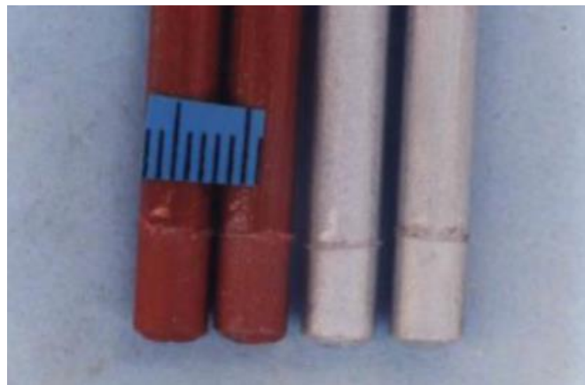
Slika 13. Elektrode za podvodno mokro REL zavarivanje [20]
