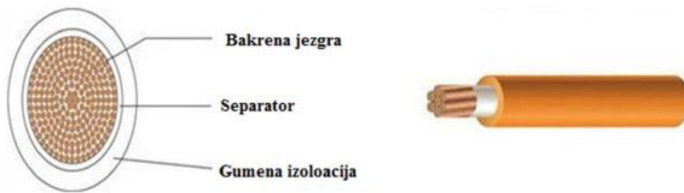
Slika 9. Kabel za podvodno zavarivanje [14]
