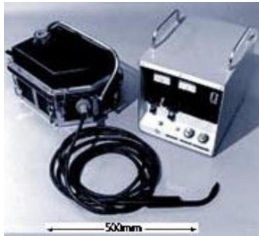
Slika 28. Oprema kod FCAW zavarivanja [5]
