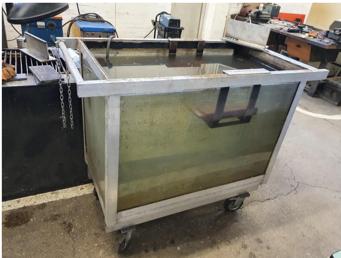
Slika 35. Bazen za izvođenje podvodnog zavarivanja
