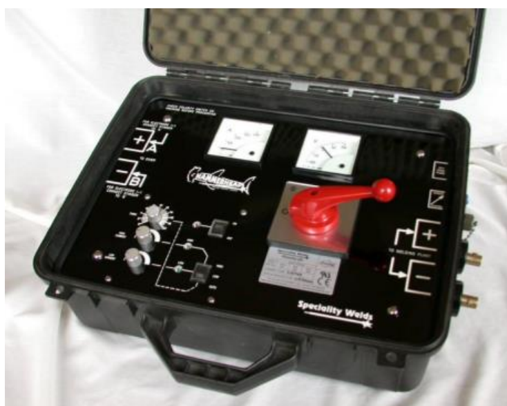
Slika 32. Izgled upravljačke ploče za podešavanje parametara zavarivanja [32]
