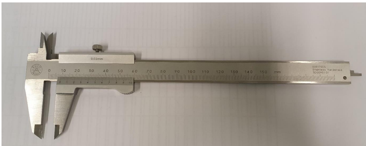
Slika 16. Ručno pomično mjerilo tvrtke Roch France
