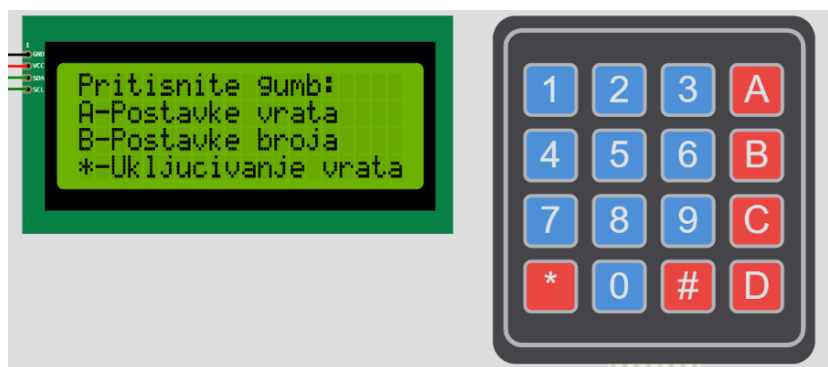
Slika 19. Glavni izbornik i matrix membranska tipkovnica
