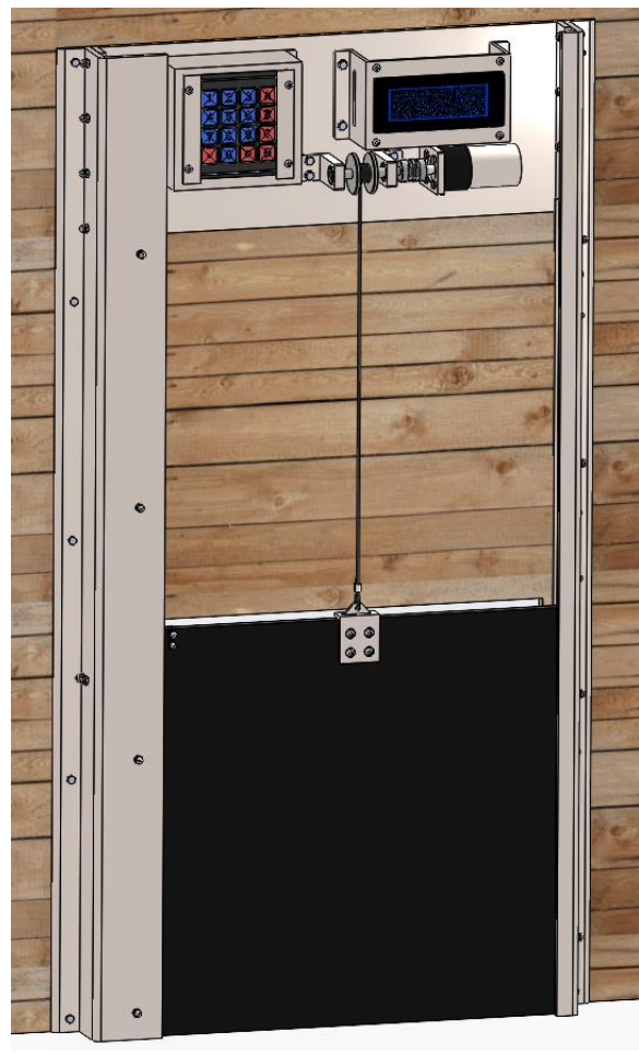
Slika 6. Zatvorena vrata bez zaštitnog lima
