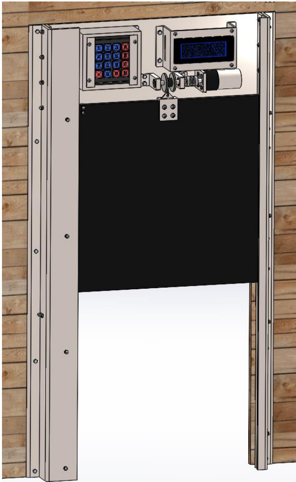
Slika 5. Otvorena vrata bez zaštitnog lima
