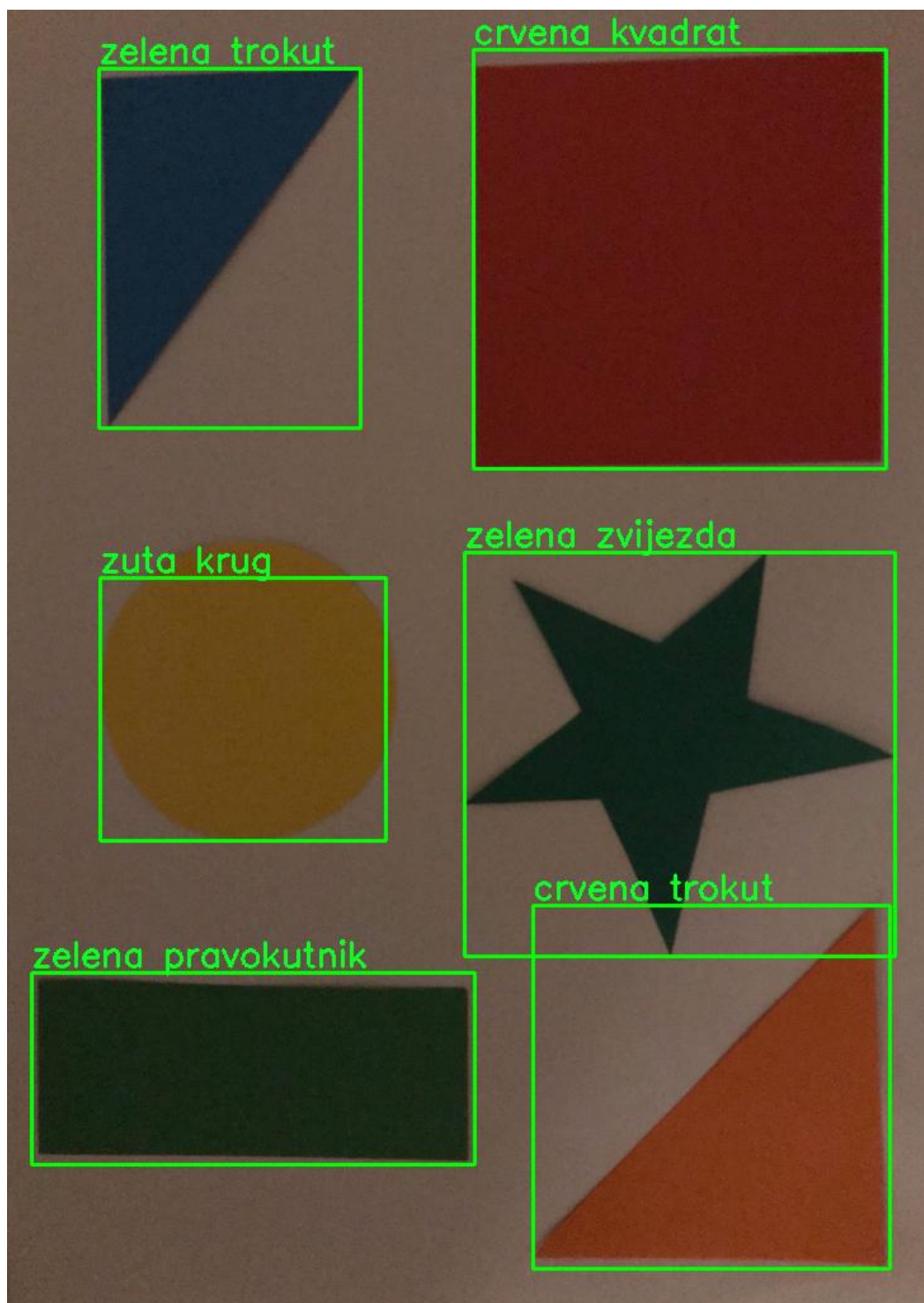
Slika 24. Detekcija objekata koristeći Tresholding i aproksimaciju kontura u tamnijem okruženju
