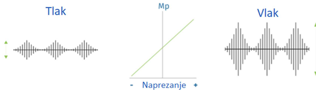
Slika 34. Djelovanje vlačnog i tlačnog naprezanja na intenzitet [27]
