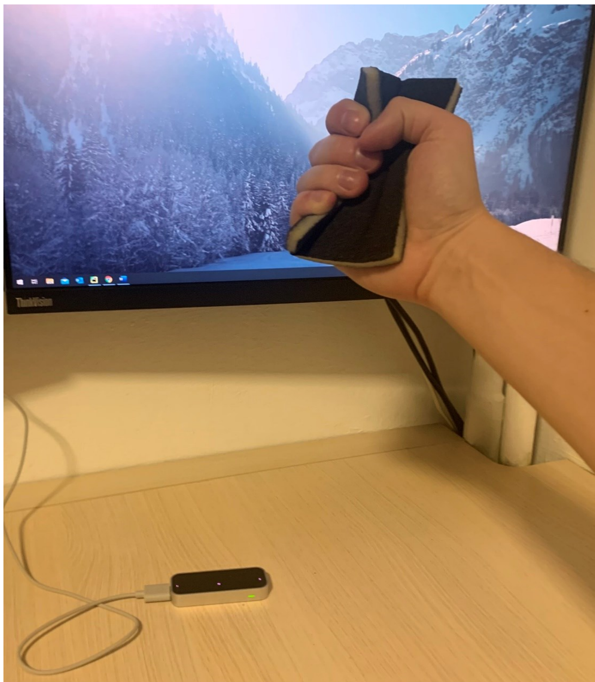
Slika 31. Krajnja pozicija mjerenja: spužva u deformiranom stanju
