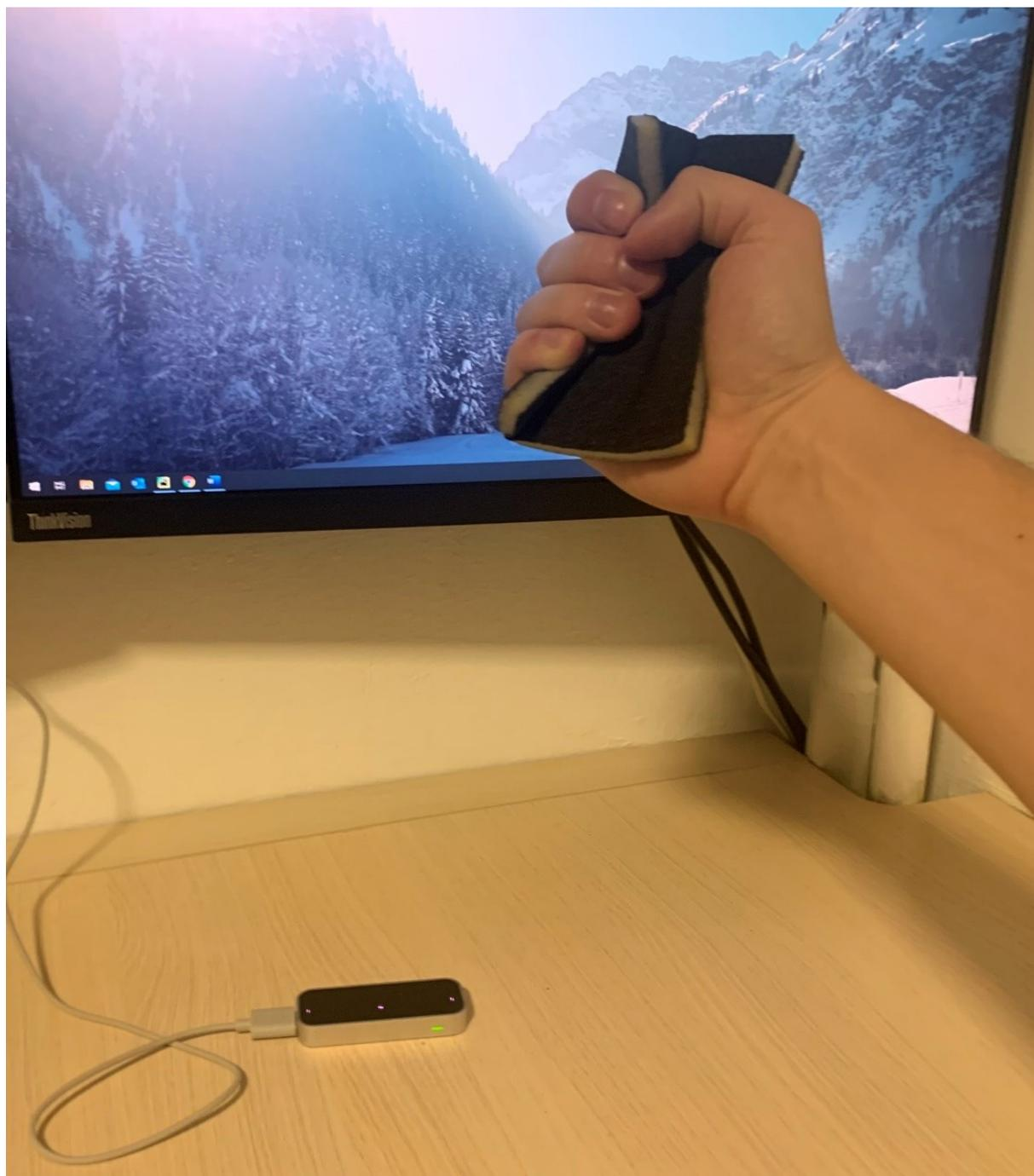
**Slika 31. Krajnja pozicija mjerenja: spužva u deformiranom stanju**
