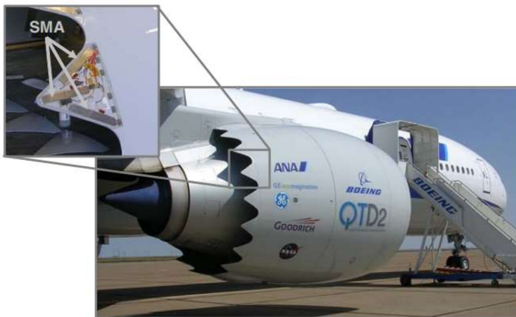
Slika 11. Valoviti uzorci na krajevima mlaznih motora Boeing aviona [17]
