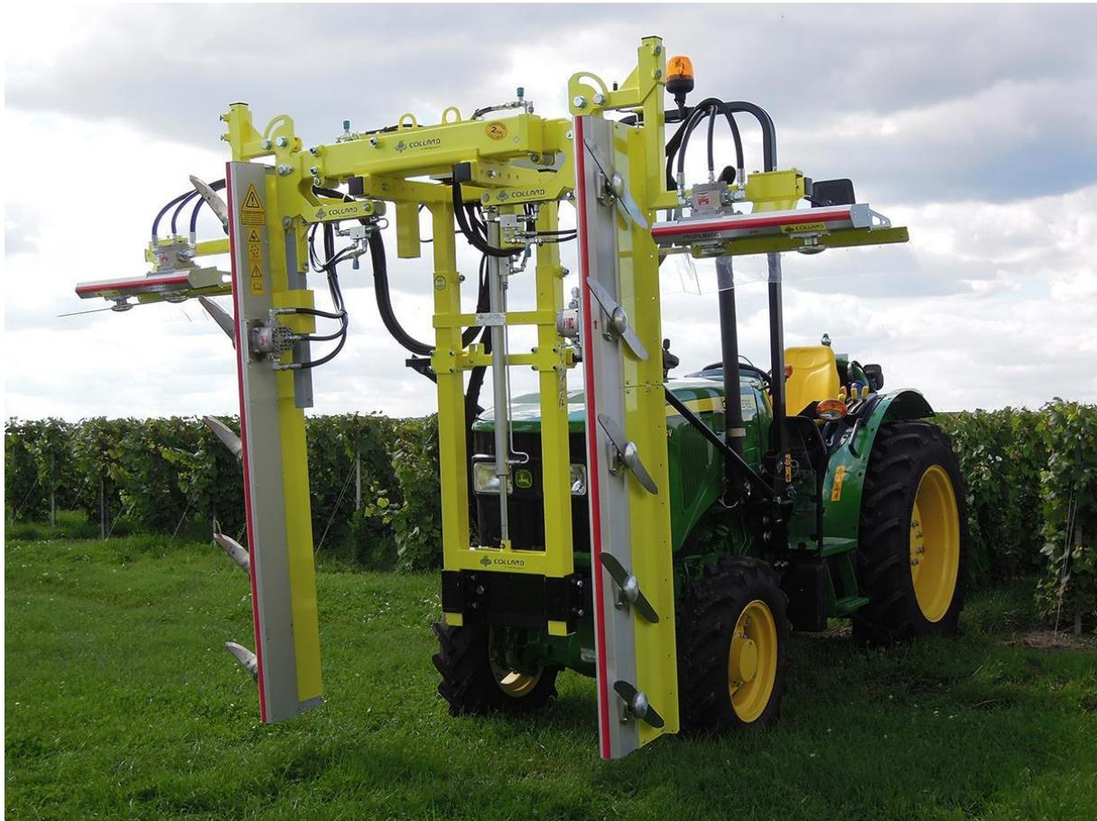
**Slika 5. Stroj za zelenu rezidbu proizvođača Collard [32]**
