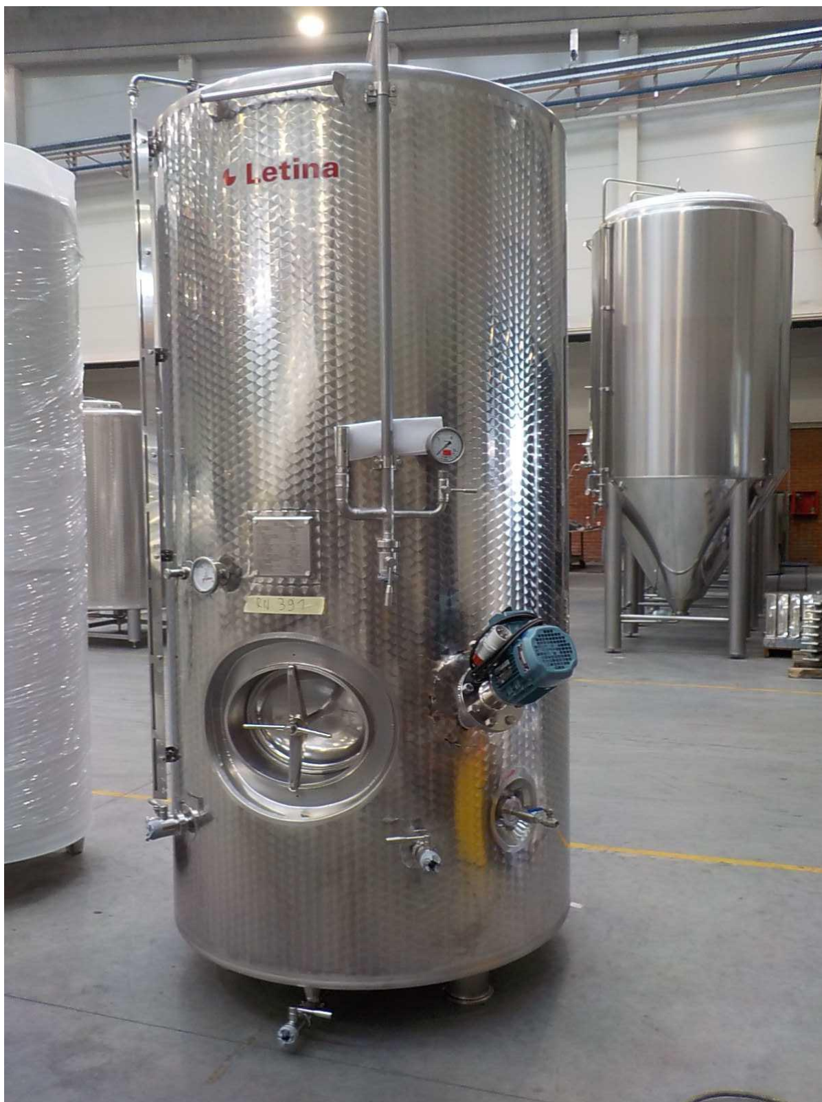
Slika 10. Spremnik za proizvodnju pjenušavog vina metodom charmat [39]
