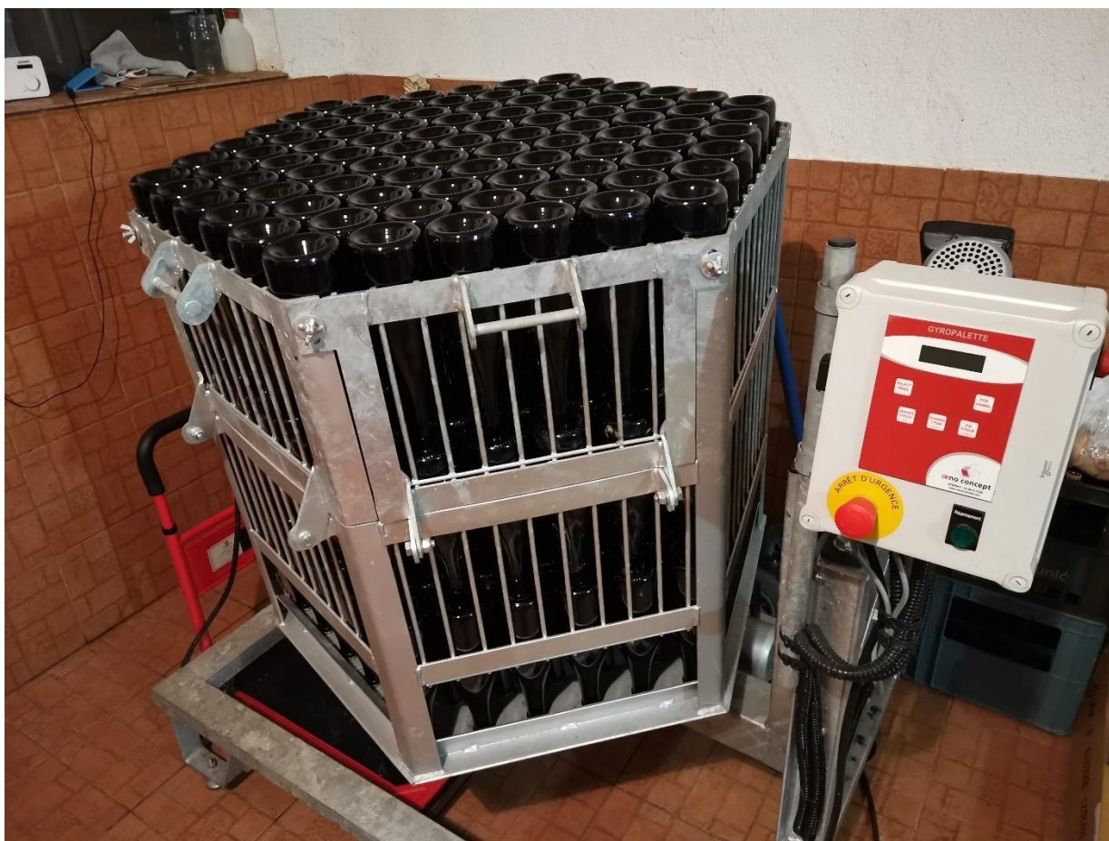
Slika 8. Giro-paletta za okretanje pjenušaca kapaciteta 300 boca
