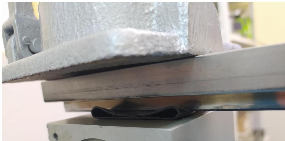
**Slika 21. Rezanje elektroizolacije**
