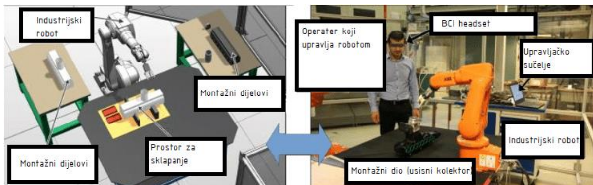
Slika 22. Prikaz industrijskog robota upravljanog BCI uređajem [60]
