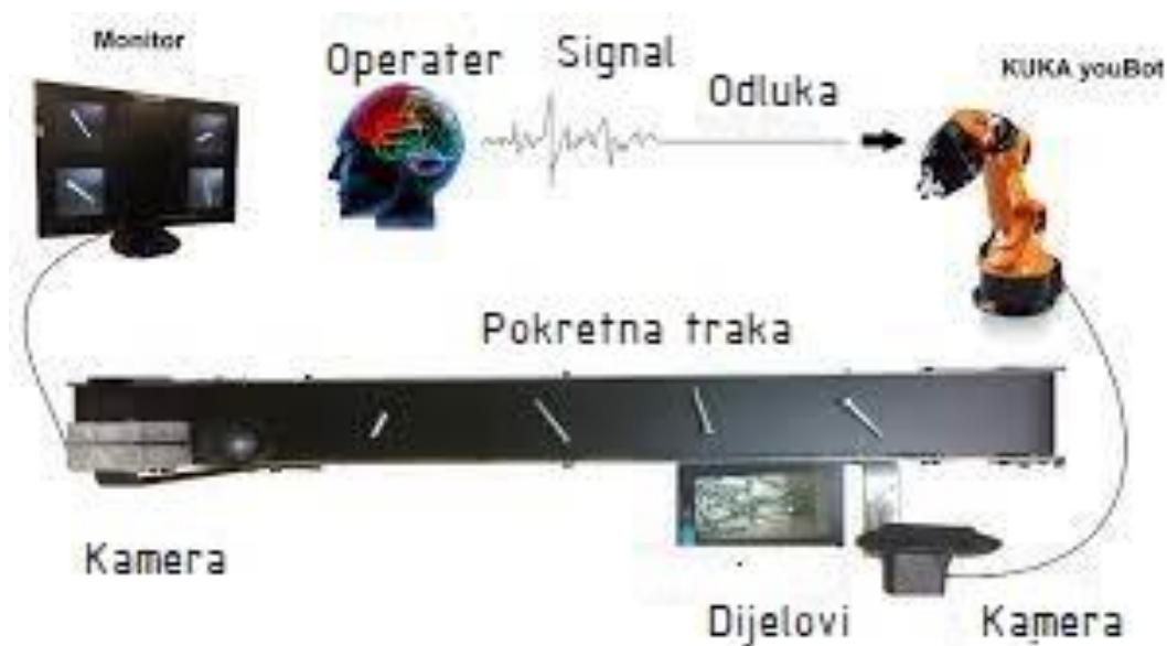
Slika 23. Sustav prepoznavanja dijelova s greškom [63]
