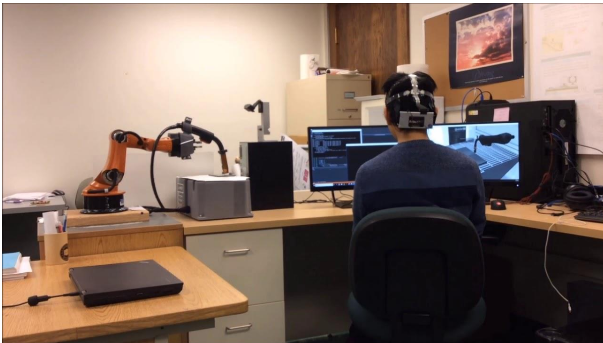
Slika 24. Zavarivanje pomoću sučelja mozak-računalo [65]
