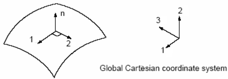
Slika 3.2.1.2. Lokalni koordinatni sustav ljuskastih elemenata [2]
