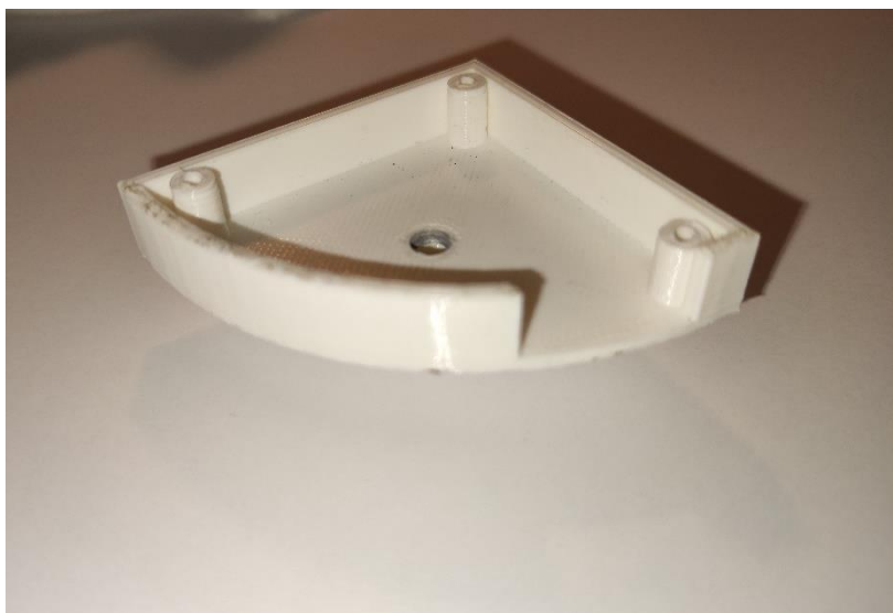
Slika 15 Kućište senzora isprintano
