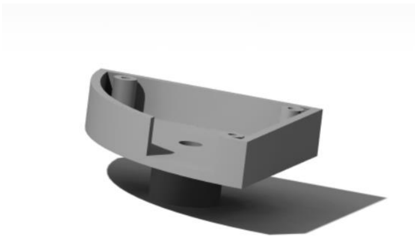
Slika 14 Kućište senzora- CAD model
