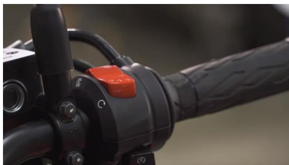
Slika 45. Sigurnosni prekidač električnog motocikla
