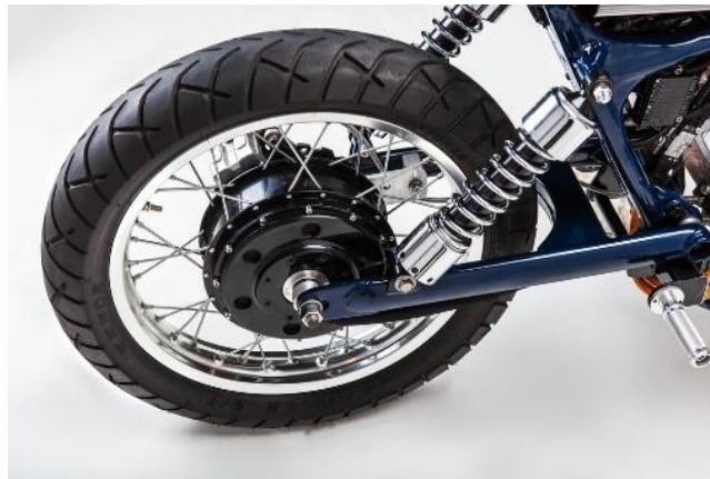
Slika 10. Elektromotor kao dio pogonskog kotača (Hub-drive)
