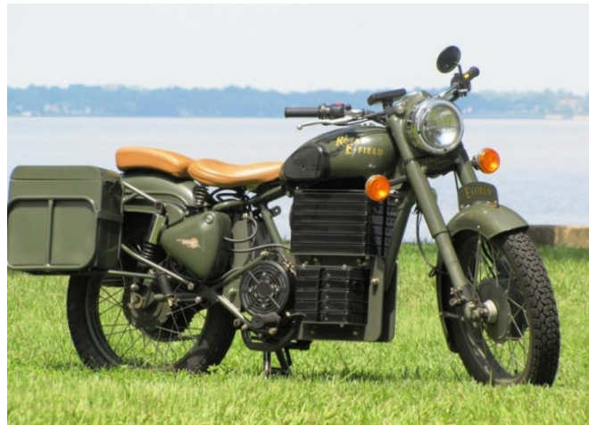
Slika 3. Royal Enfield Bullet 500 nakon konverzije na električni pogon
