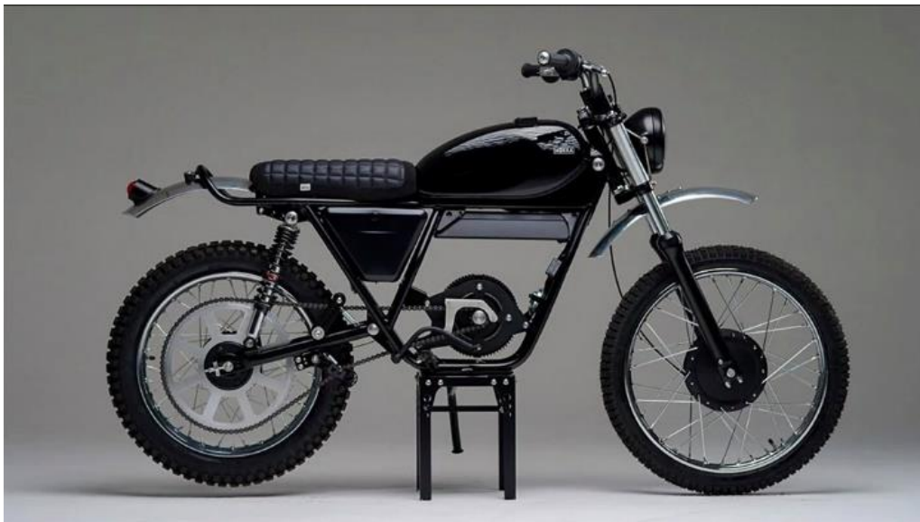
Slika 11. Elektromotor unutar šasije motocikla (Mid-drive)
