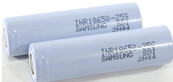
Slika 23. Samsung INR18650-25S baterijska ćelija
