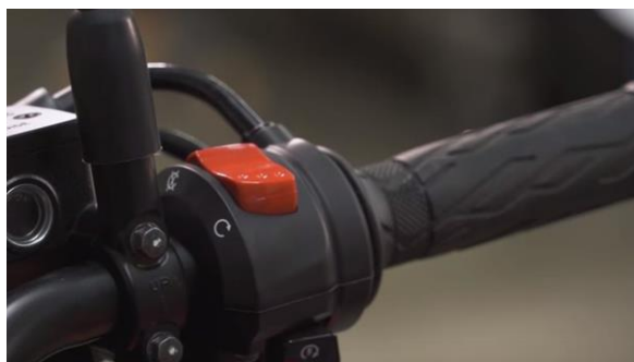
Slika 45. Sigurnosni prekidač električnog motocikla
