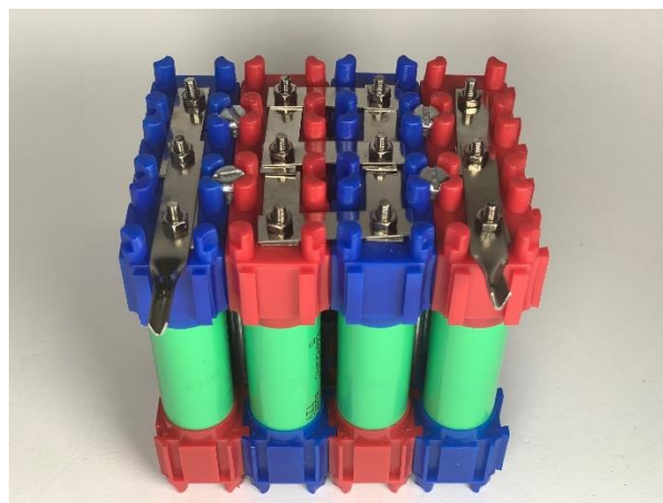
Slika 28. Graničnici sa ugrađenom sabirnicom
