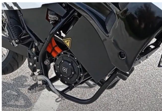
Slika 44. Narančaste instalacije i naljepnica za upozorenje
