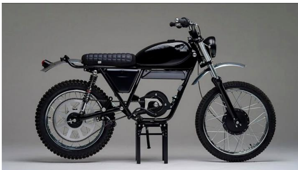
Slika 11. Elektromotor unutar šasije motocikla (Mid-drive)
