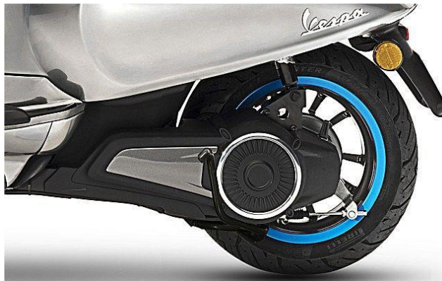
Slika 8. Elektromotor kao dio ovješene mase motocikla
