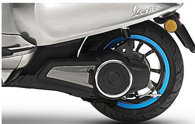
Slika 8. Elektromotor kao dio ovješene mase motocikla
