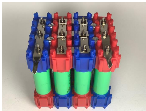
Slika 28. Graničnici sa ugrađenom sabirnicom
