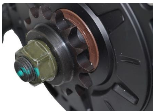
Slika 41. Pogonski lančanik na elektromotoru
