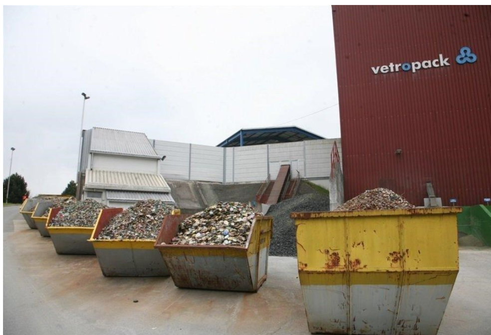
Slika 35. Otpadne frakcije nakon recikliranja staklene ambalaže [43]
