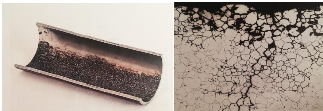
Slika 14. Primjeri interkristalne korozije [10]
