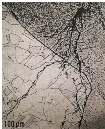
Slika 16. Kloridna napetosna korozija zavarenog spoja [11]
