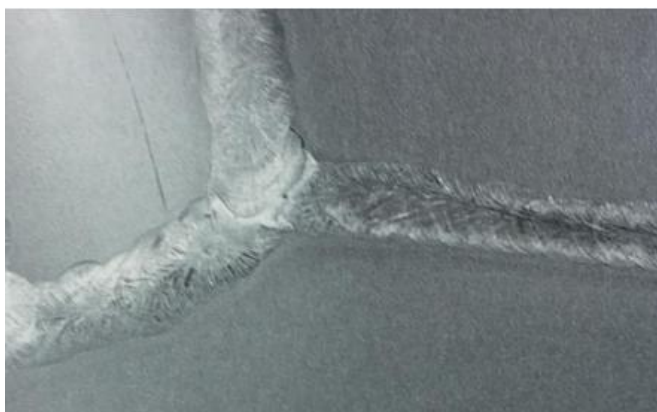
Slika 37. Zavareni spoj nakon kemijske obrade [5]
