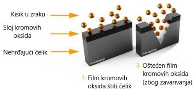
Slika 31. Prikaz oštećenja nehrđajućeg čelika zbog oštećivanja zaštitnog sloja [15]
