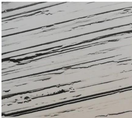
Slika 36. Izgled fino brušene površine nehrđajućeg čelika EN 1.4404 [1]
