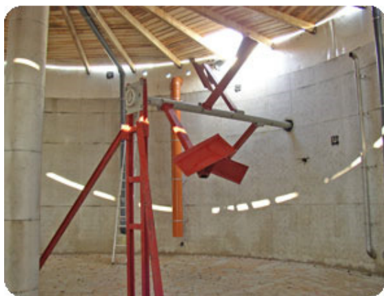
Slika 2.27. Miješalica s horizontalnom osovinom
