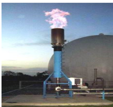
Slika 2.31. Baklja za bioplin
