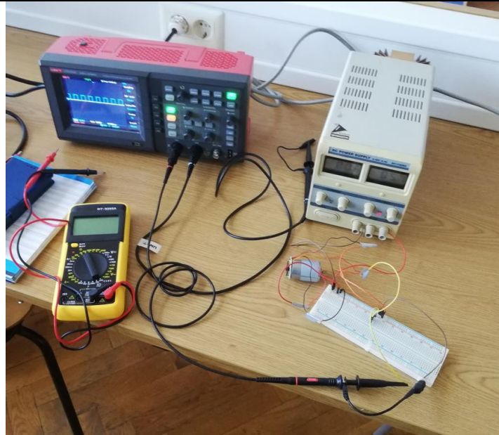
Slika 24. Ispitivanje karakteristika enkodera
