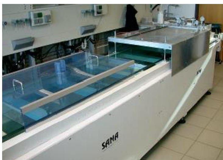
Slika 22. Uređaj za lijevanje keramičke folije [22]
