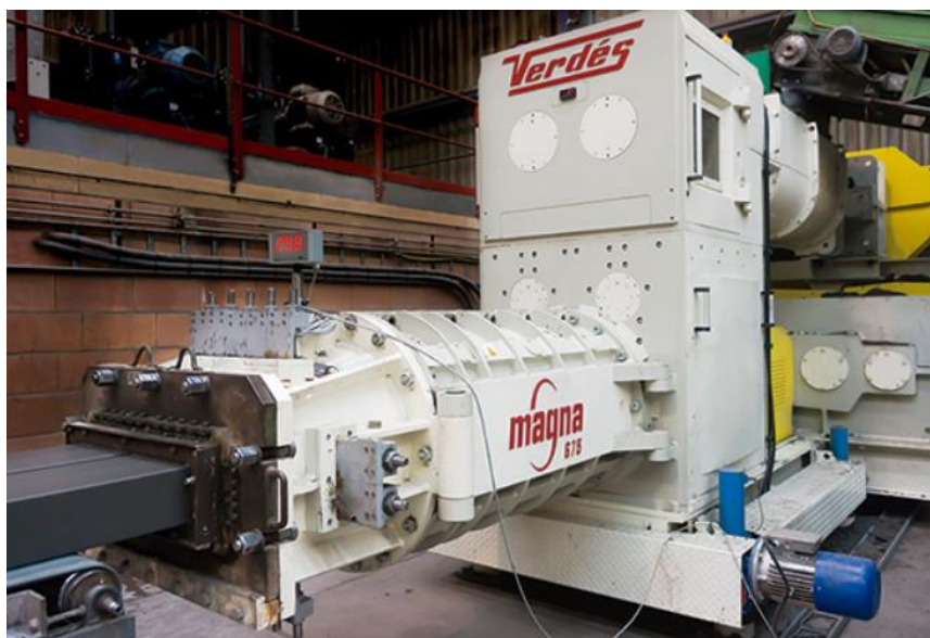
Slika 30. Ekstruder sa sklopnim jedinicama za proizvodnju [29]
