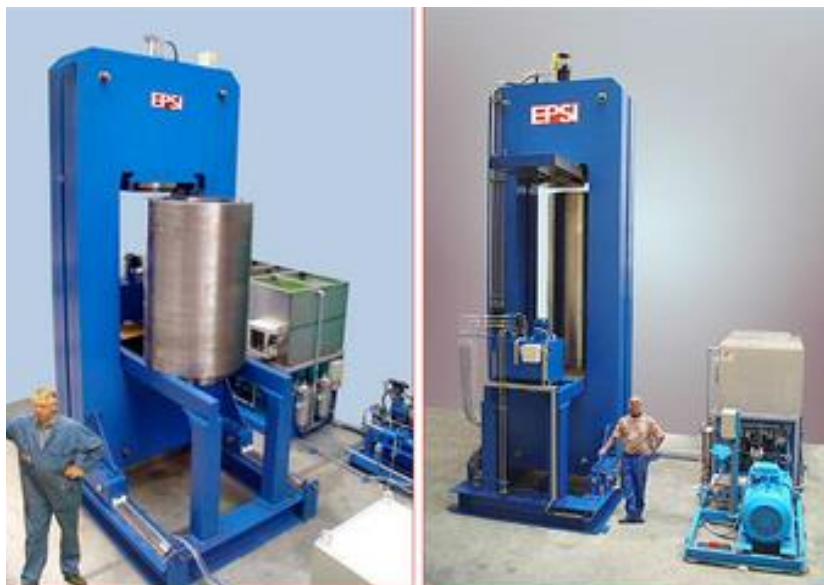
Slika 14. Stanica za hladno izostatičko prešanje [16]
