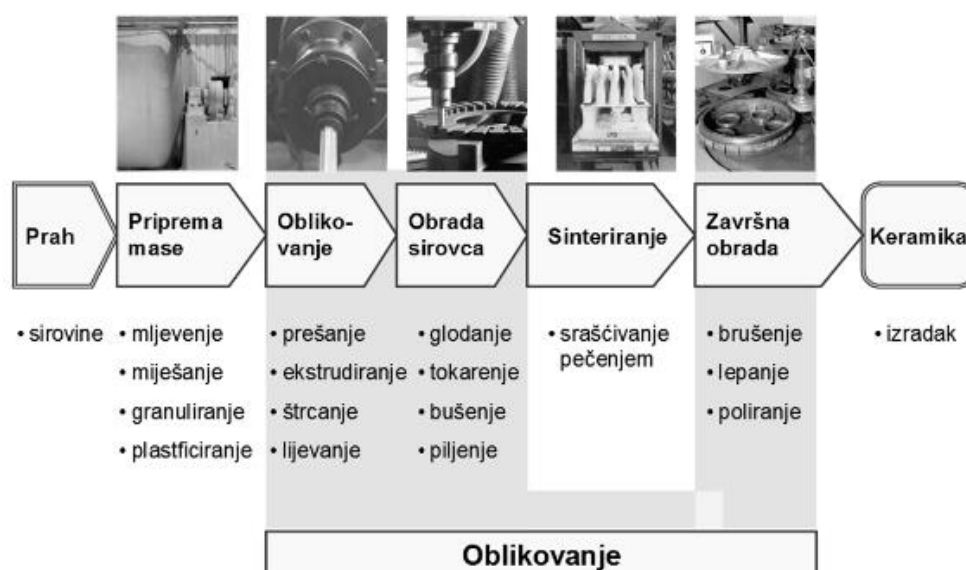
Slika 7. Bitne faze procesa proizvodnje tehničke keramike [4]
