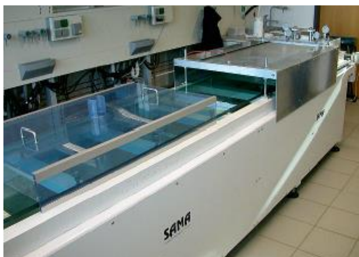
Slika 22. Uređaj za lijevanje keramičke folije [22]
