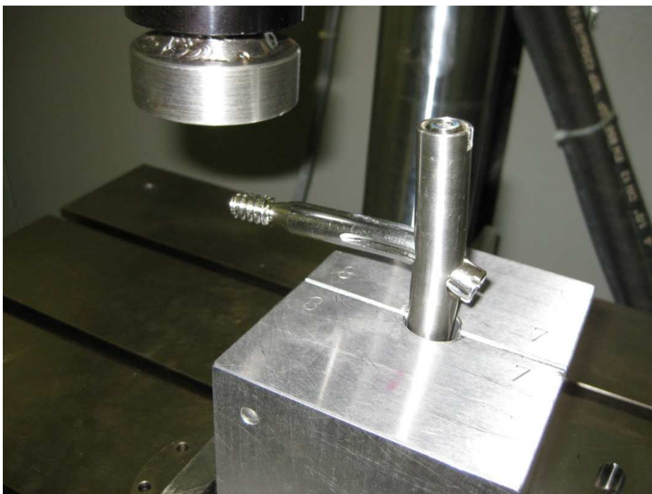
Slika 4.8 Deformacija gama čavla nakon statičkog ispitivanja
