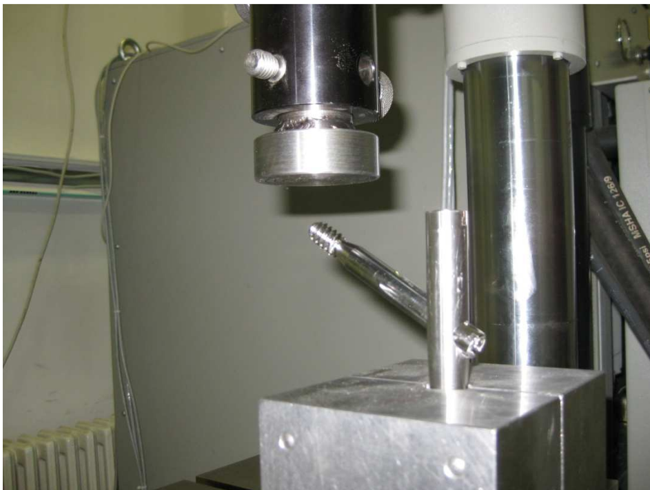
Slika 4.7 Pozicionirani uzorak za statički eksperiment
