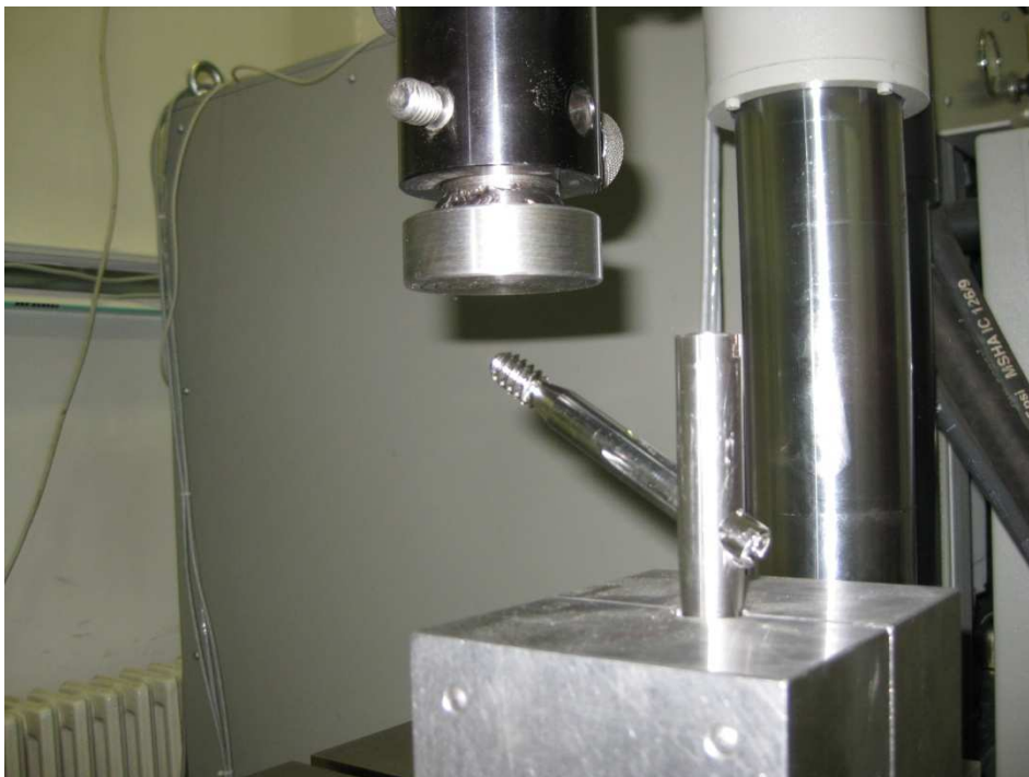
Slika 4.7 Pozicionirani uzorak za statički eksperiment
