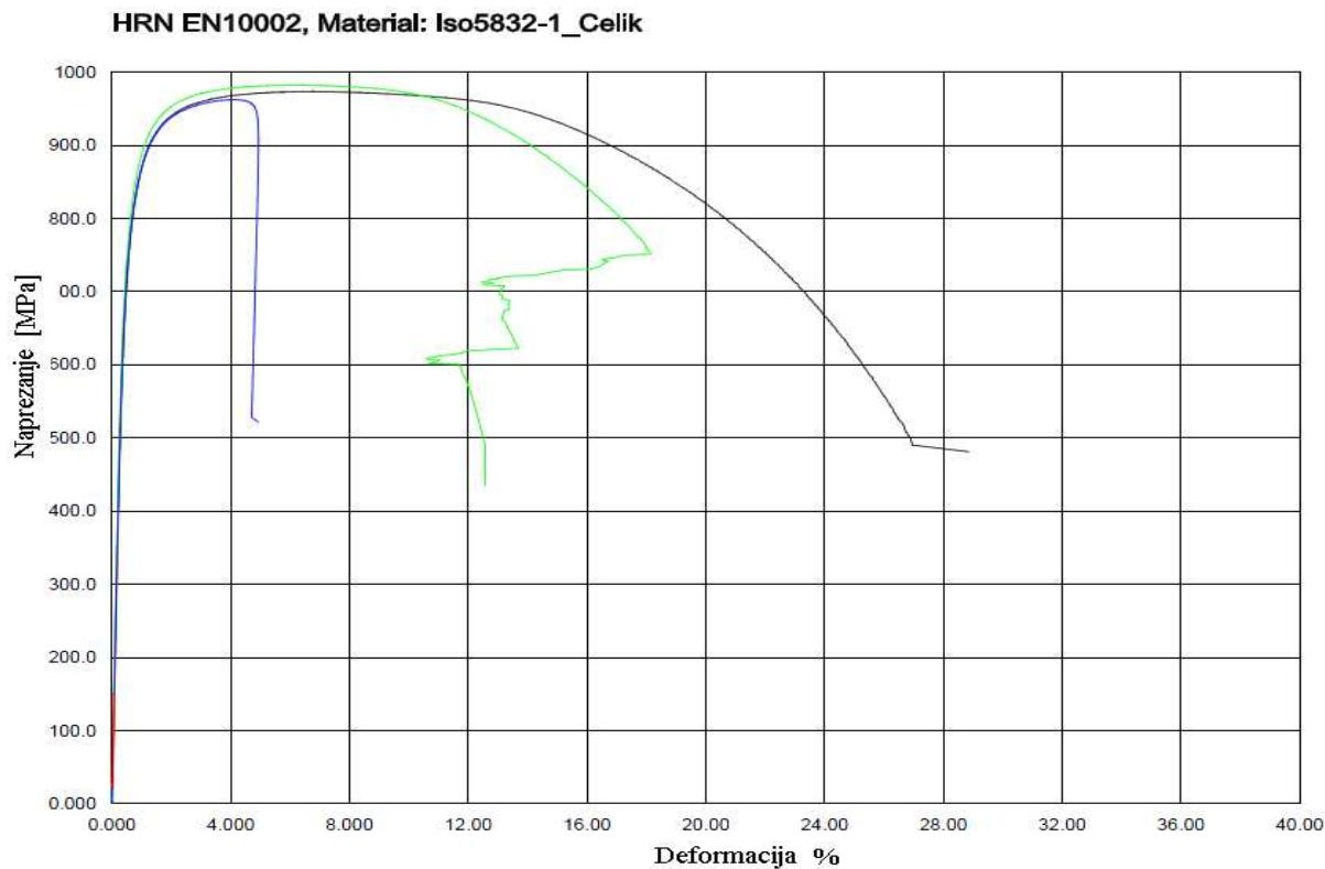
Slika 6.10 Dijagram naprezanje-deformacija za materijal prema ISO 5832-1
