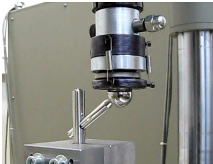
Slika 4.9 Pozicionirani uzorak za dinamičko ispitivanje
