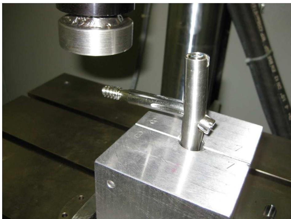
Slika 4.8 Deformacija gama čavla nakon statičkog ispitivanja
