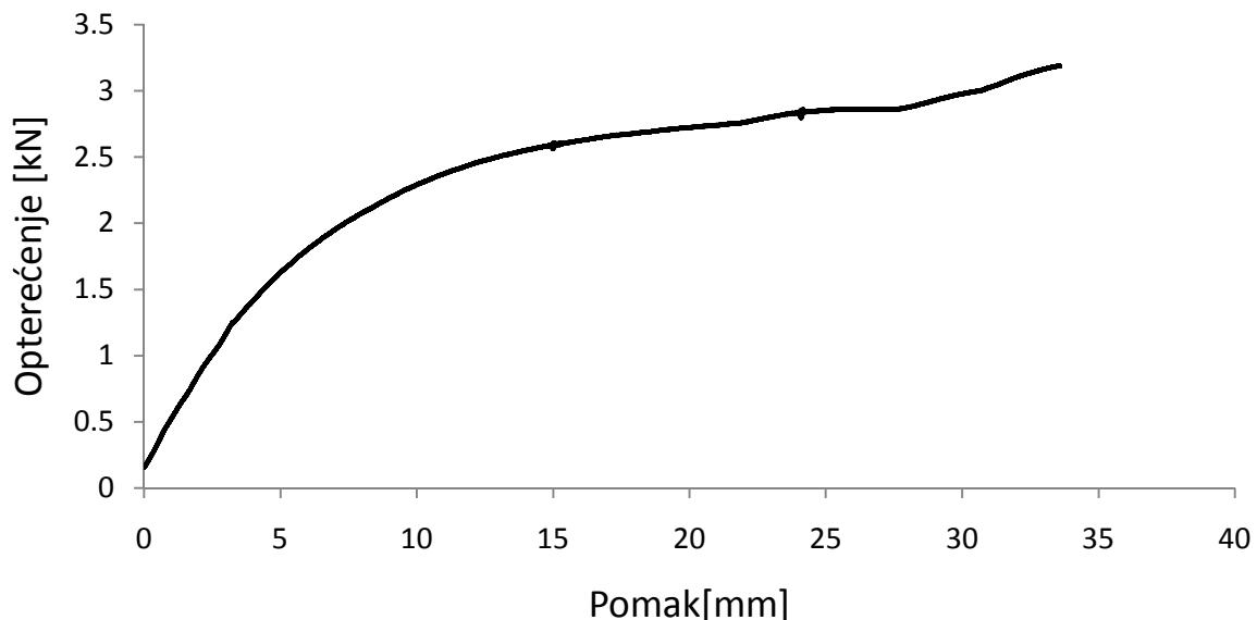
Slika 5.1 Dijagram opterećenje-pomak pri statičkom ispitivanju
