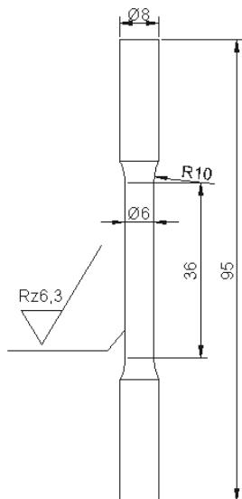
Slika 6.9 Dimenziije epruvete za statički vlačni pokus
