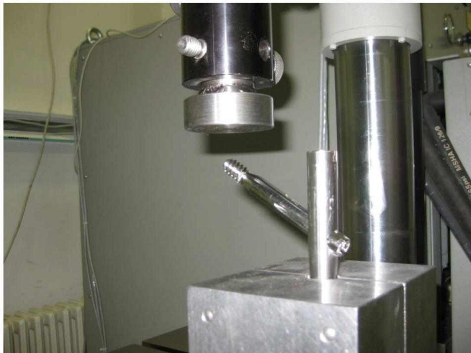
Slika 4.7 Pozicionirani uzorak za statički eksperiment
