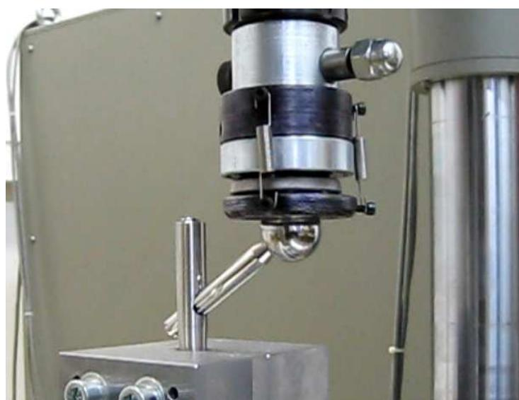
Slika 4.9 Pozicionirani uzorak za dinamičko ispitivanje
