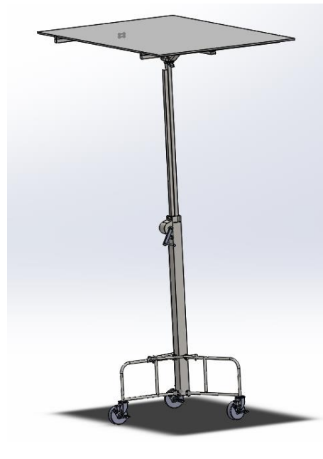
Slika 7. Montaža ploče na strop
