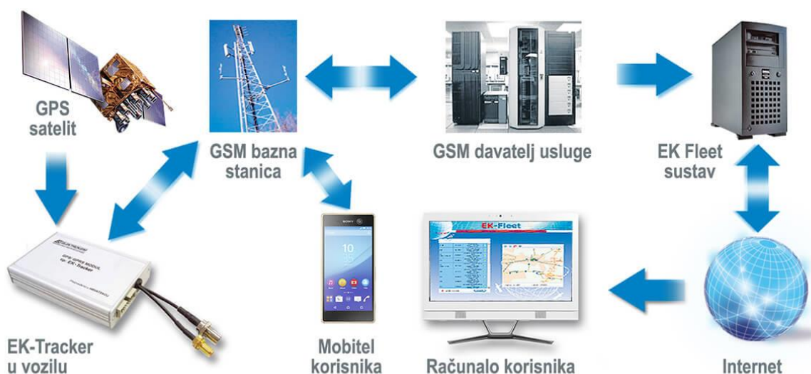
Slika 8. Princip rada EK-Fleet sustava, [39]
