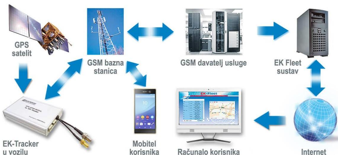
Slika 8. Princip rada EK-Fleet sustava, [39]
