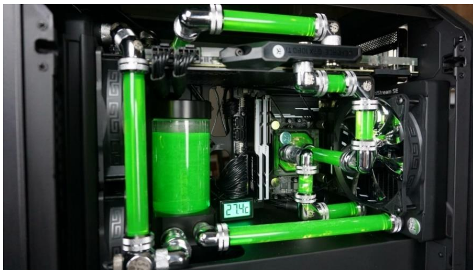
Slika 8. DIY (do it yourself) sustav vodenog hlađenja [12]
