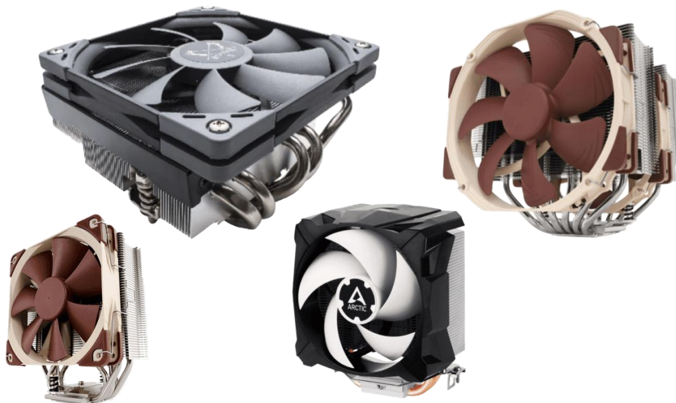
Slika 14. Različiti oblici ventilatora hladnjaka računalnog procesora [14]
